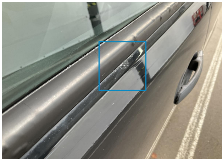
33. Door / Front Left Paint / Corrosion -
