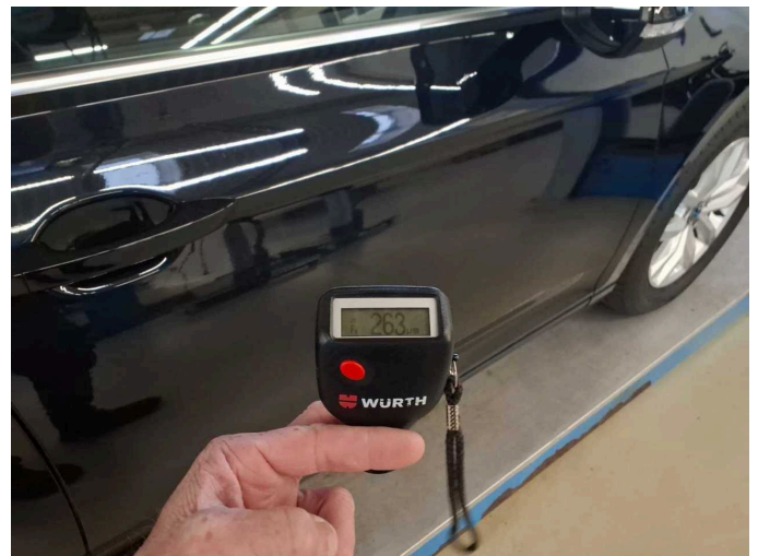
Door - front right side: 263 µm
