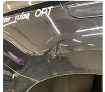
7.4.9 - Bakskärm höger :: Buckla skärm bak, kräver rikt av plåt och omlack 5*5 cm
