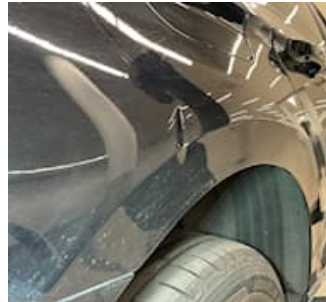
7.4.9 - Bakskärm höger :: Buckla skärm bak, kräver rikt av plåt och omlack 5*5 cm
