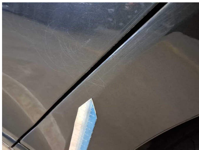
Beschädigung 6: Seitenwand links: Seitenwand - Kratzer - lackieren
