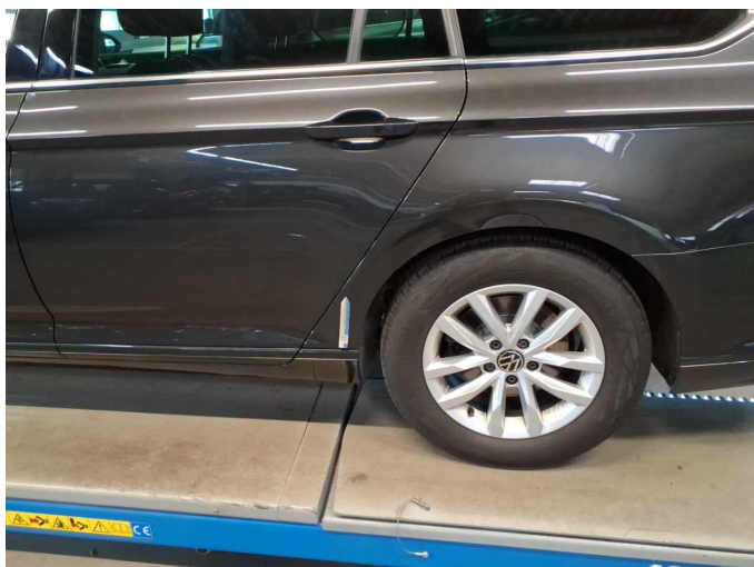
Beschädigung 6: Seitenwand links: Seitenwand - Kratzer - lackieren
