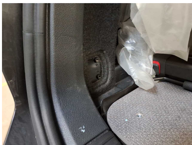
Fehlteil 1: Ausrüstung: Verzurröse (Beide, hinten) - fehlt - erneuern
