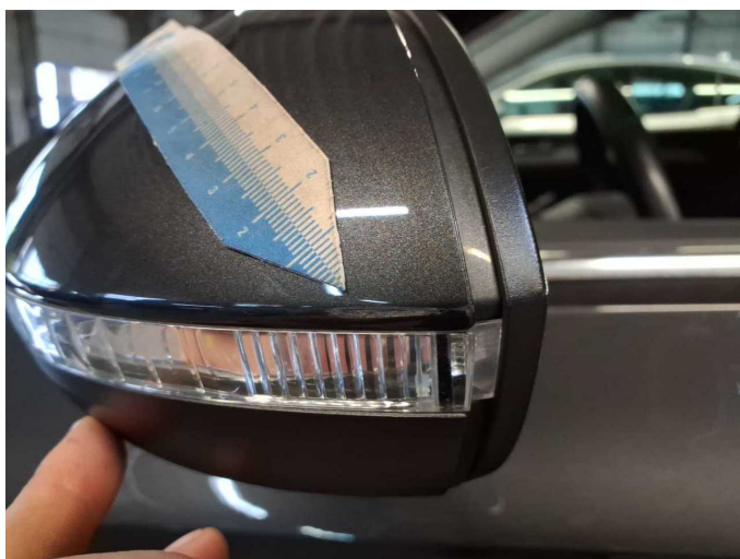
Beschädigung 2: Außenspiegel links: Abdeckkappe - Kratzer - Smart Repair
