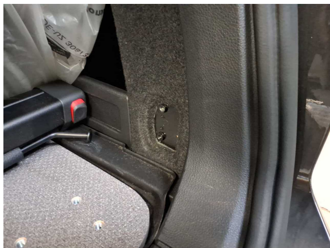
Fehlteil 1: Ausrüstung: Verzurröse (Beide, hinten) - fehlt - erneuern
