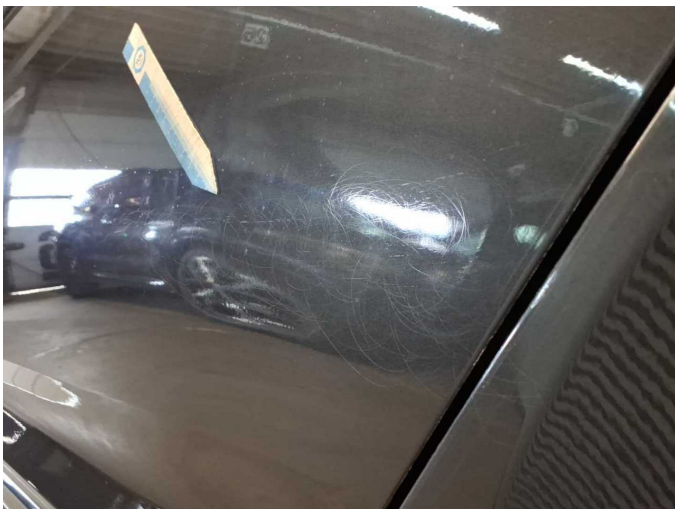
Beschädigung 5: Tür hinten links: Tür (Verkratzt) - verformt - instandsetzen und lackieren
