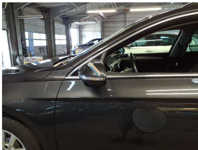
Beschädigung 2: Außenspiegel links: Abdeckkappe - Kratzer - Smart Repair
