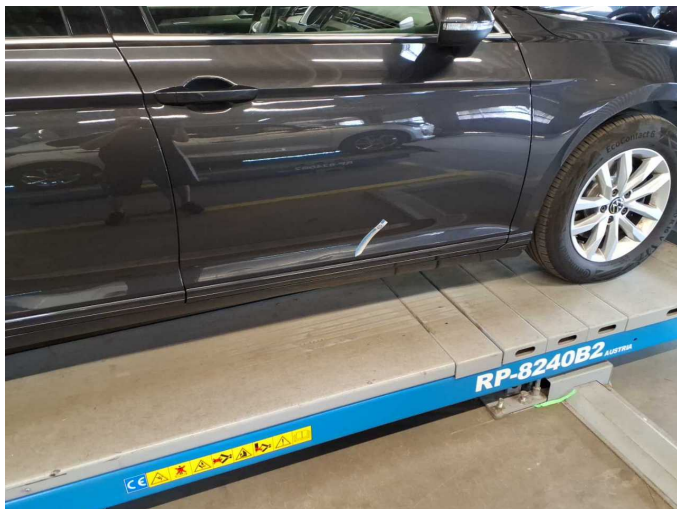
Beschädigung 4: Tür vorn rechts: Tür (Wellig, Leiste geht ab.) - nicht fachgerecht instandgesetzt - instandsetzen und lackieren
