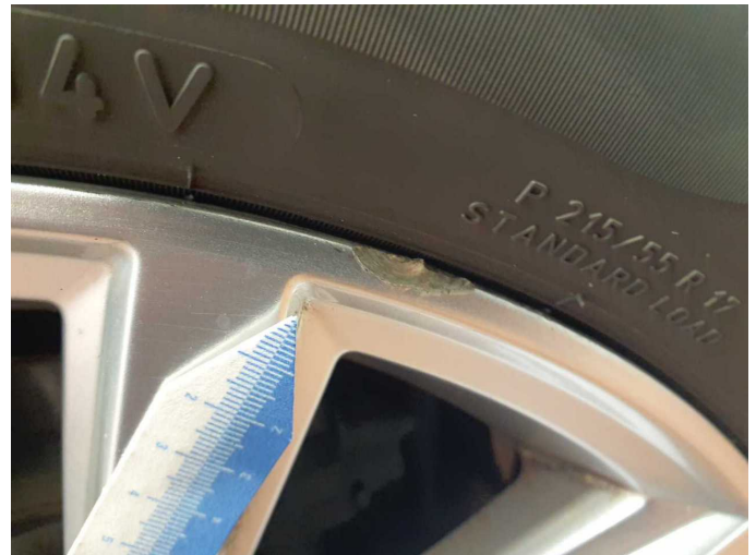
Beschädigung 8: Rad/Reifen: Leichtmetallfelge vorn rechts - beschädigt - erneuern
