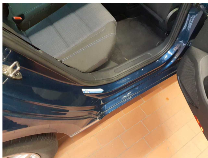
Beschädigung 5: Seitenwand rechts: Einstieg - Kratzer - Smart Repair
