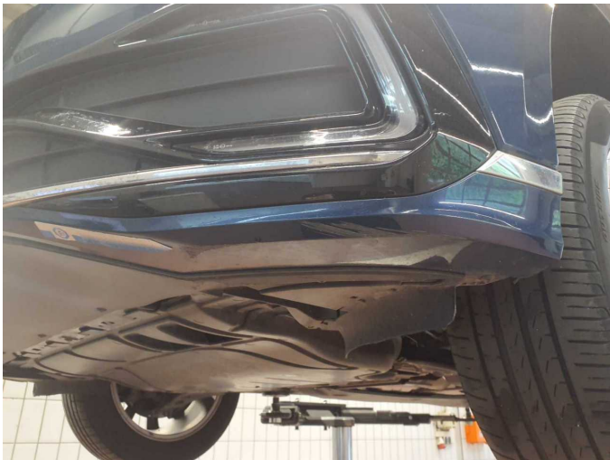
Beschädigung 7: Stossfänger vorn: Spoiler - verkratzt / verschürft - lackieren
