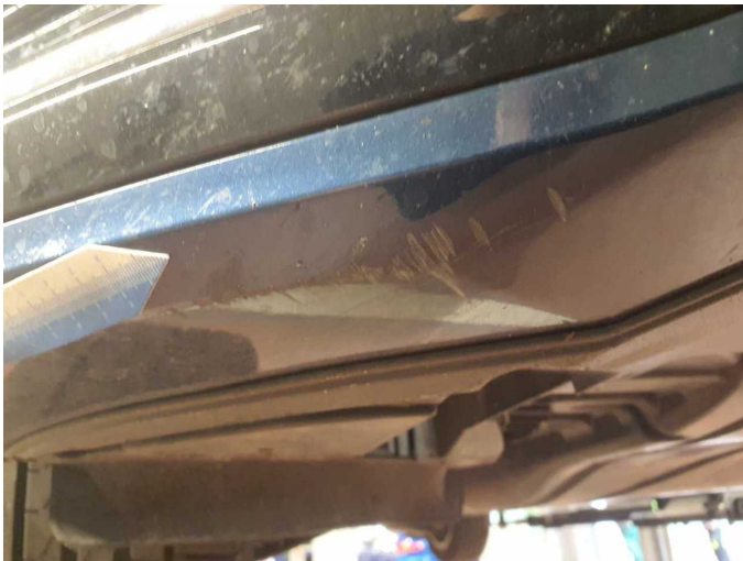
Beschädigung 7: Stossfänger vorn: Spoiler - verkratzt / verschürft - lackieren
