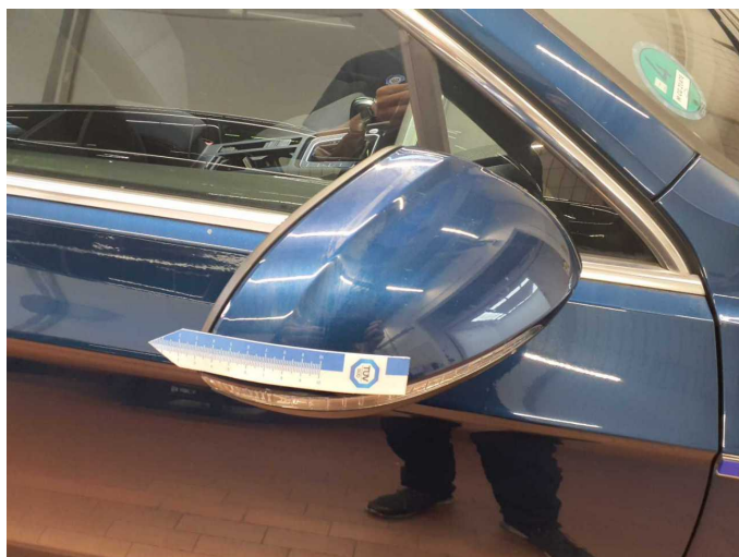
Beschädigung 2: Außenspiegel rechts: Abdeckkappe - Kratzer - Smart Repair
