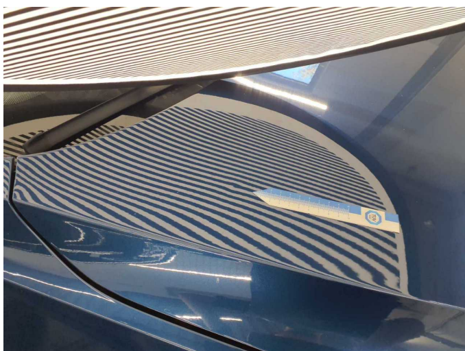
Beschädigung 10: Motorhaube: Motorhaube - Delle / Lackschaden - instandsetzen und lackieren
