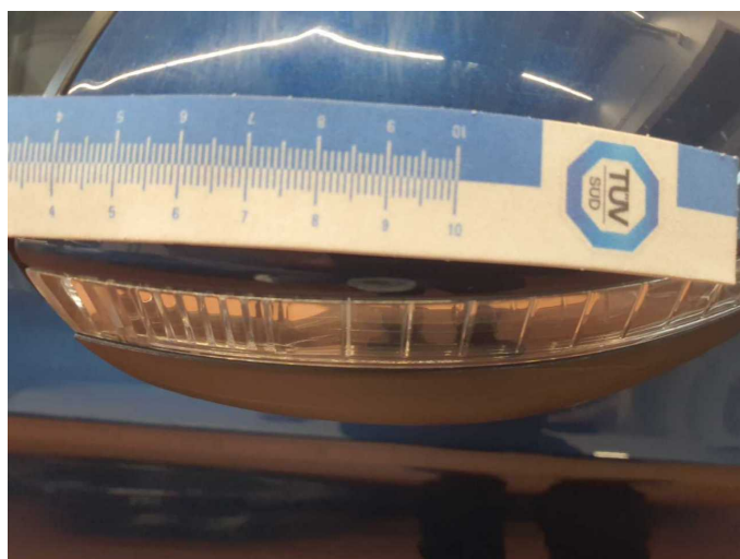
Beschädigung 2: Außenspiegel rechts: Abdeckkappe - Kratzer - Smart Repair
