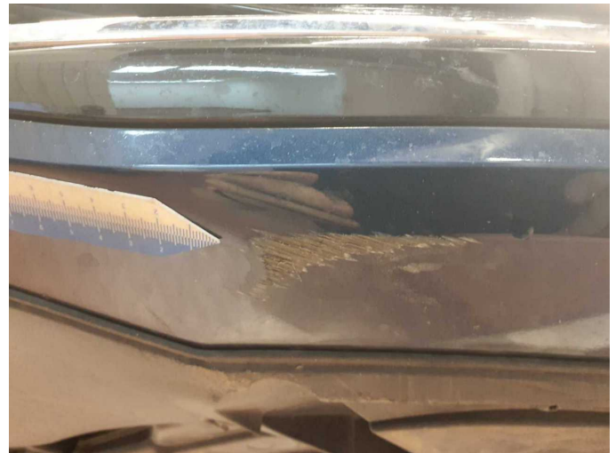
Beschädigung 7: Stossfänger vorn: Spoiler - verkratzt / verschürft - lackieren
