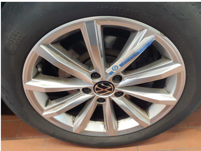
Beschädigung 8: Rad/Reifen: Leichtmetallfelge vorn rechts - beschädigt - erneuern
