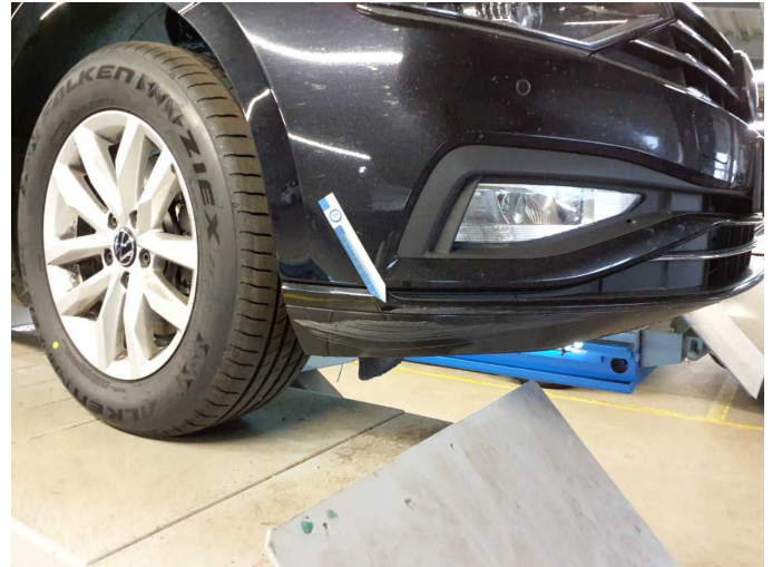
Beschädigung 9: Stossfänger vorn: Spoiler - verkratzt / verschürft - lackieren
