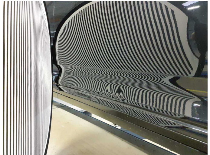
Beschädigung 10: Tür vorn rechts: Tür - verformt - instandsetzen und lackieren
