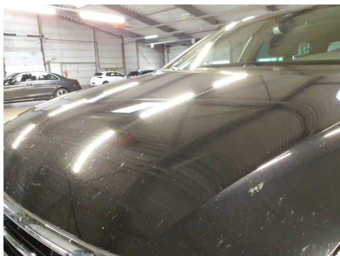
Beschädigung 11: Motorhaube: Motorhaube (Dellen) - Steinschlag - instandsetzen und lackieren
