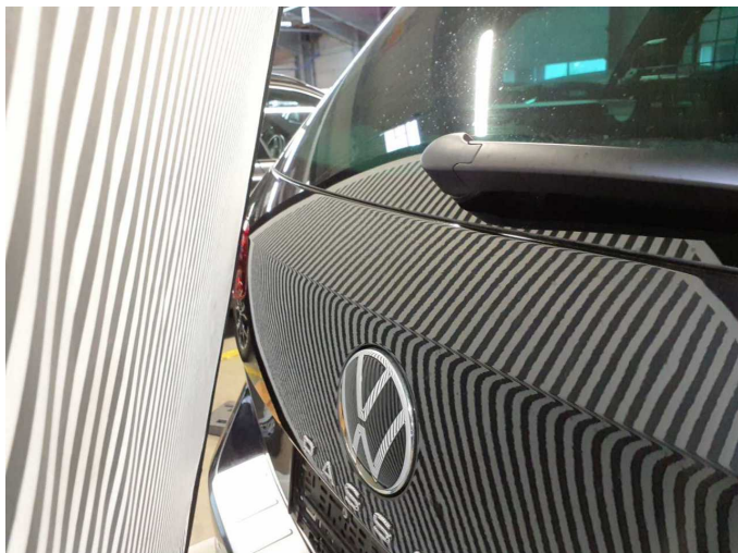
Beschädigung 5: Heckklappe/-tür: Heckklappe - Delle(n) - sanft instandsetzen
