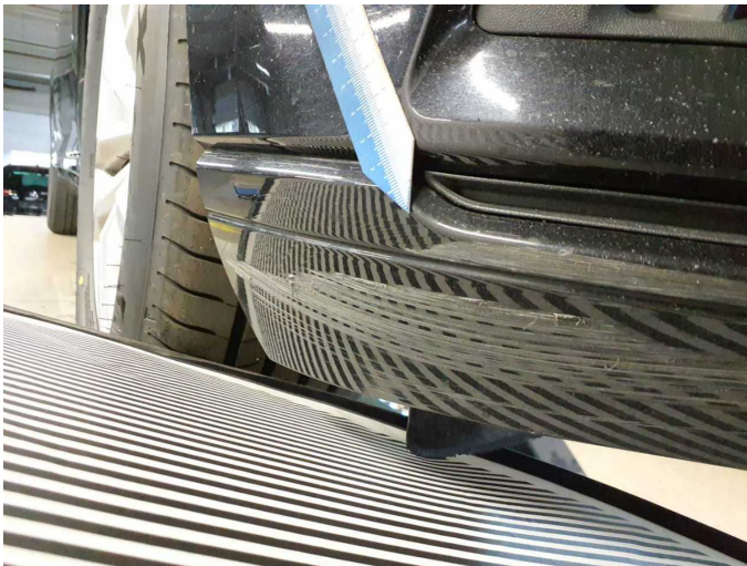
Beschädigung 9: Stossfänger vorn: Spoiler - verkratzt / verschürft - lackieren
