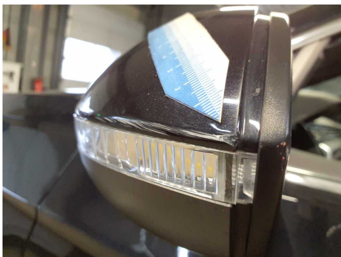
Beschädigung 7: Außenspiegel links: Abdeckkappe - gebrochen / gerissen - erneuern
