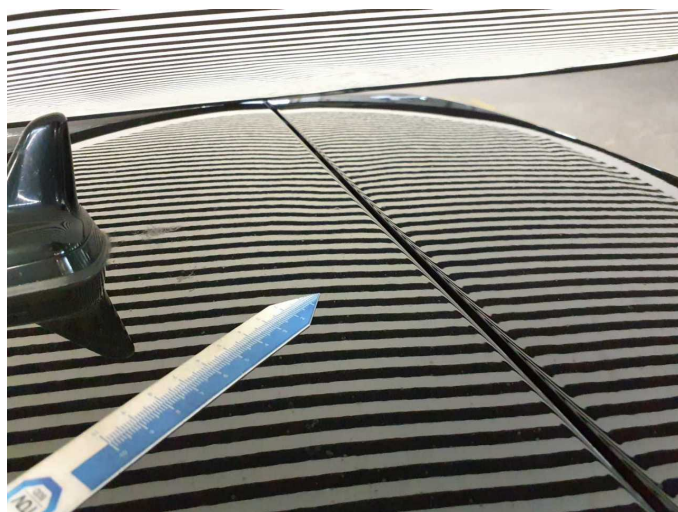
Gebrauchsspur 11: Fahrzeugdach: Dach (Kratzer) - Delle(n) - sanft instandsetzen
