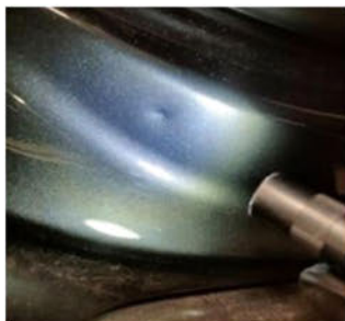
7.4.18 - Tröskel/insteg höger bakdörr :: Rikt och lack normalt slitage
