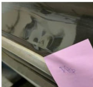
7.4.5 - Bakdörr höger :: Rikt och lack
