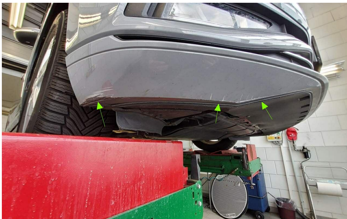
Bild 22 : Stoßfänger vorne verschrammt
