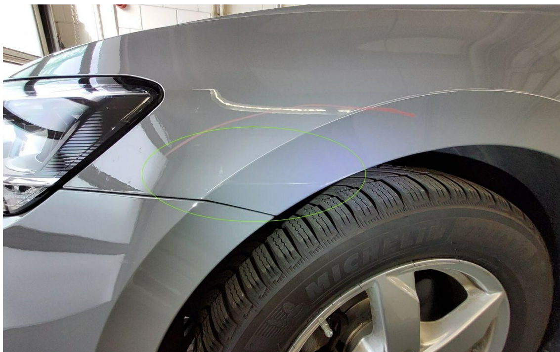
Bild 20 : Kotflügel links angefahren
