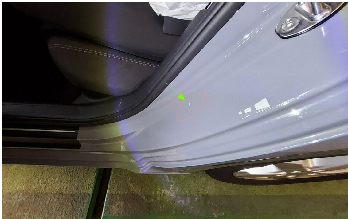
Bild 17 : Türeinstieg hinten links verschrammt
