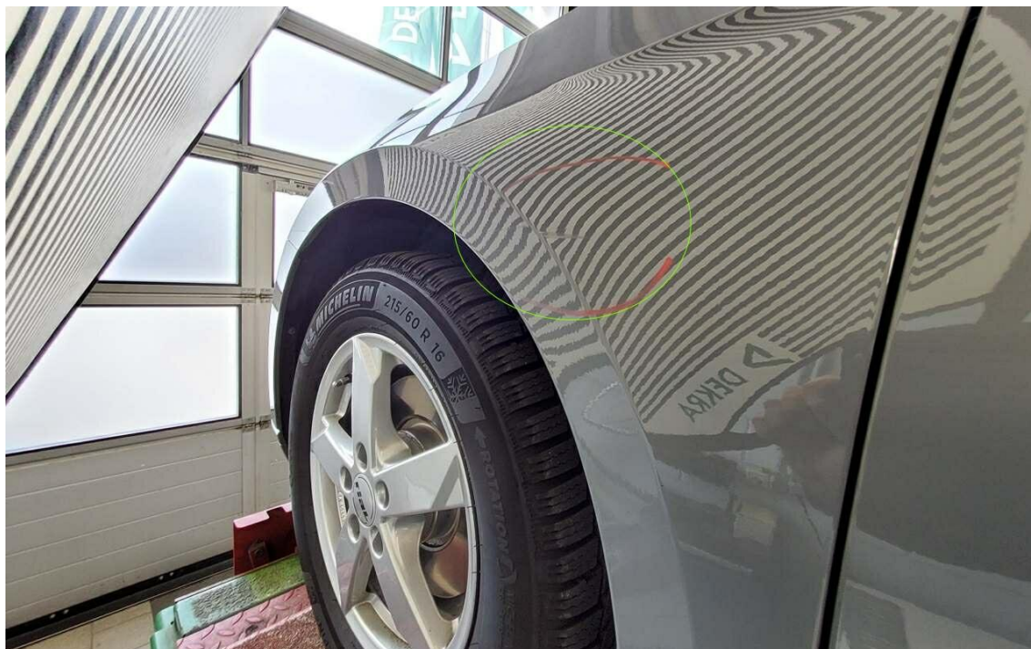
Bild 19 : Kotflügel links angefahren
