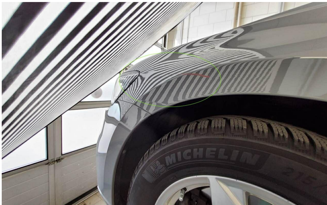
Bild 18 : Kotflügel links angefahren
