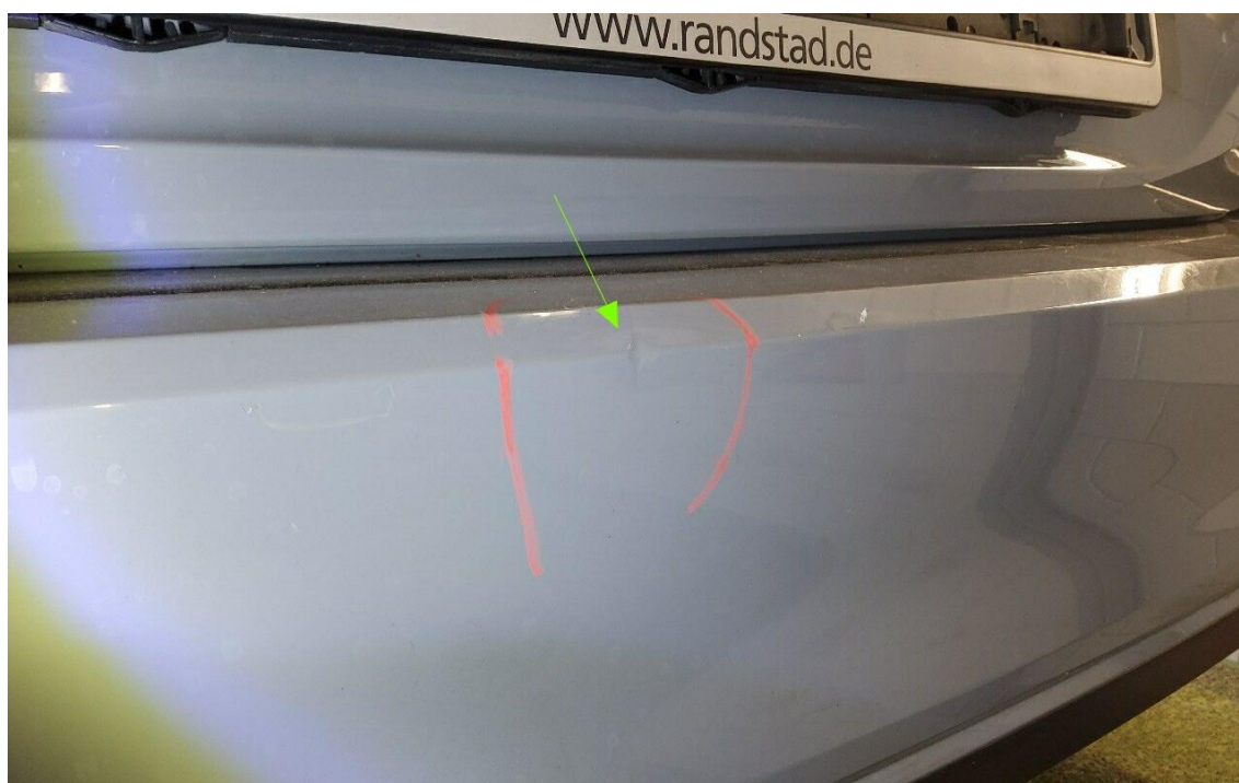
Bild 25 : Stoßfänger hinten verschrammt/deformiert
