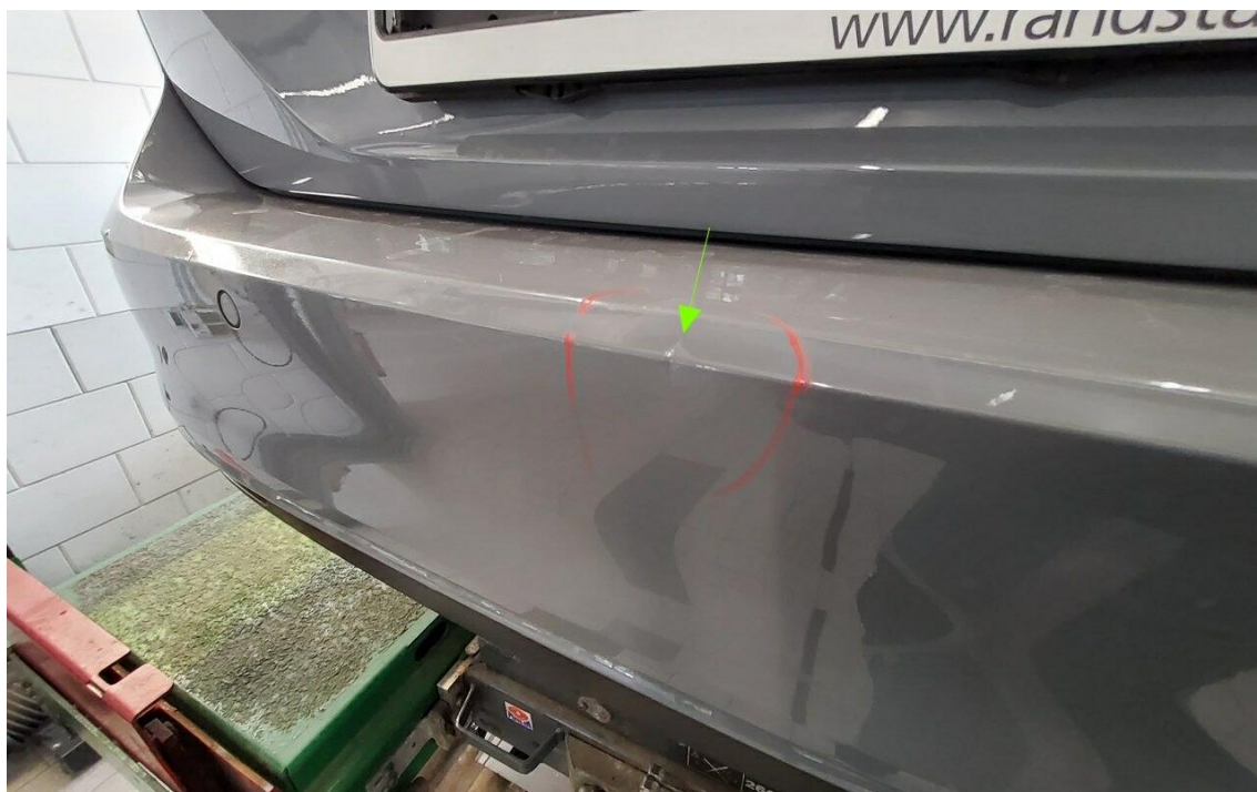
Bild 24 : Stoßfänger hinten verschrammt/deformiert
