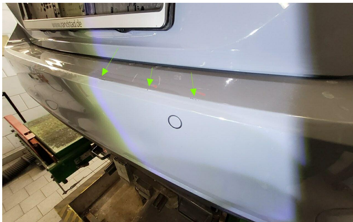
Bild 26 : Stoßfänger hinten verschrammt/deformiert
