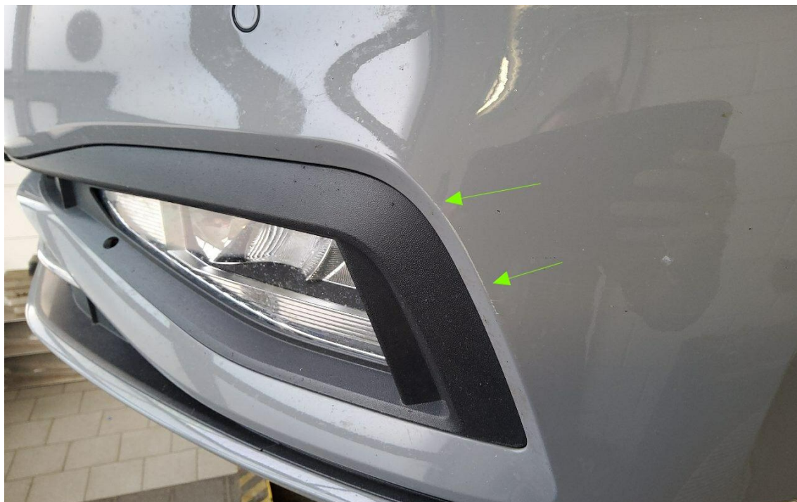
Bild 23 : Stoßfänger vorne verschrammt
