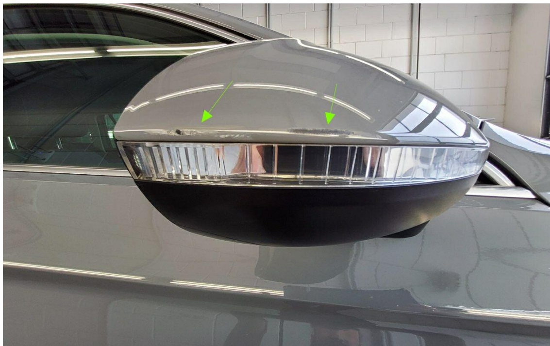
Bild 27 : Spiegelkappe rechts verschrammt
