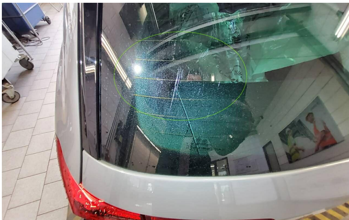
Bild 16 : T- Heckscheibe verschrammt
