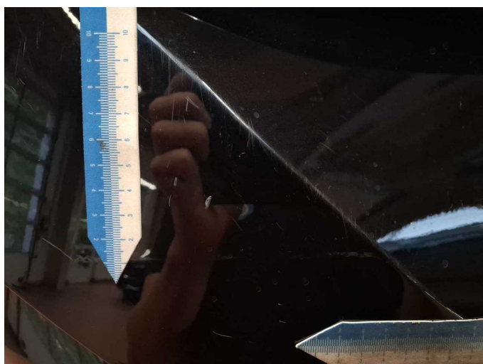
Beschädigung 15: Heckklappe/-tür: Heckklappe - Delle / Lackschaden - instandsetzen und lackieren
