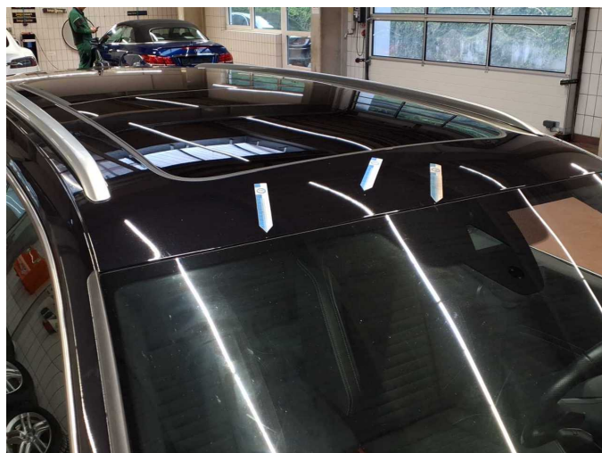
Beschädigung 18: Fahrzeugdach: Dach - Korrosion - lackieren
