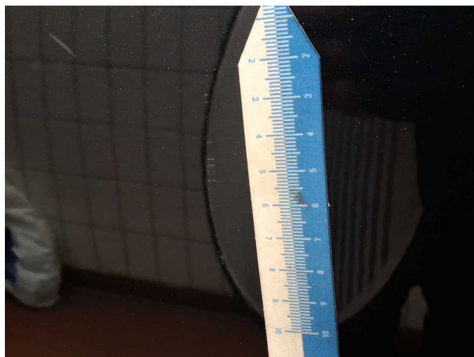
Beschädigung 19: Tür hinten rechts: Tür - Delle(n) - instandsetzen und lackieren
