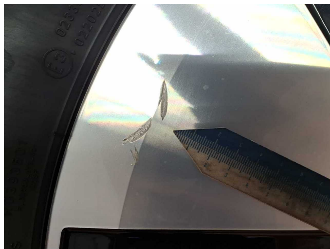
Beschädigung 10: Rad/Reifen: Leichtmetallfelge hinten rechts - verkratzt / verschürft - Wertminderung
