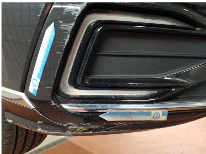
Beschädigung 5: Stossfänger vorn: Stossfänger vorn rechts (Blende) - verkratzt / verschürft - erneuern
