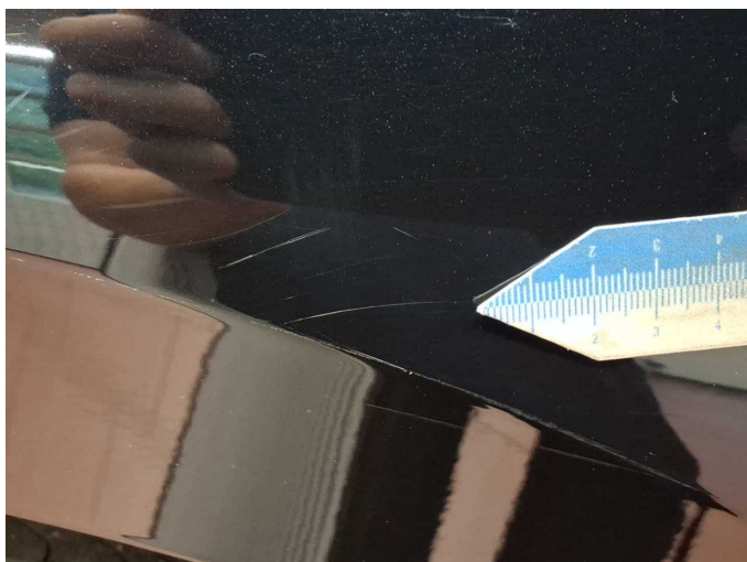
Beschädigung 8: Seitenwand links: Seitenwand - Kratzer - Smart Repair
