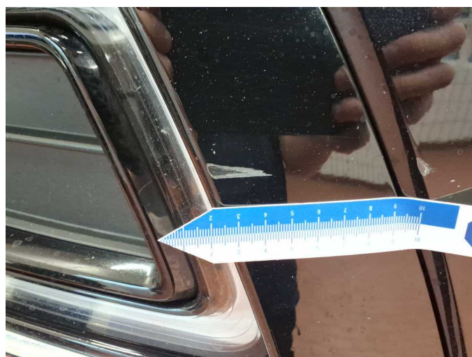
Beschädigung 4: Stossfänger vorn: Stossfänger vorn links (Blende) - verkratzt / verschürft - erneuern
