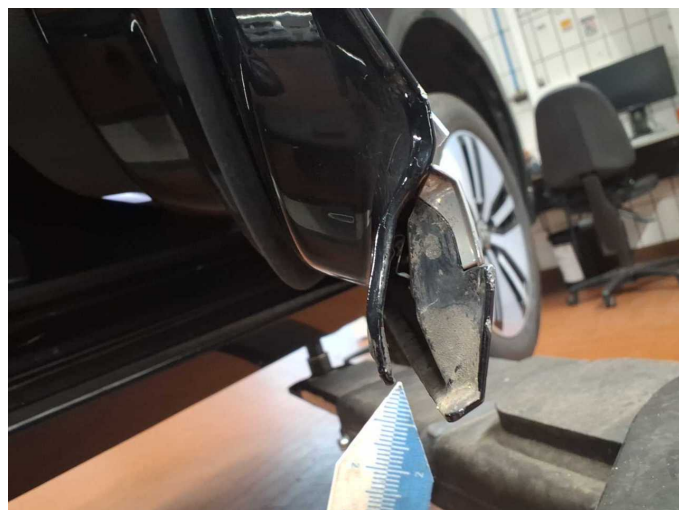
Beschädigung 1: Tür vorn rechts: Zierleiste unten - lose - de-/montieren
