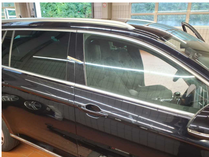
Beschädigung 2: Tür vorn rechts: Zierleiste oben - beschädigt - erneuern
