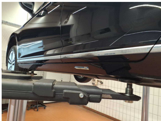
Beschädigung 6: Schweller links: Verkleidung - Kratzer - Smart Repair
