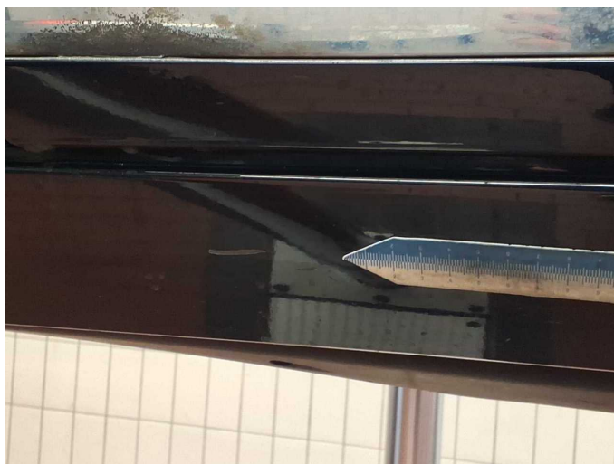
Beschädigung 6: Schweller links: Verkleidung - Kratzer - Smart Repair
