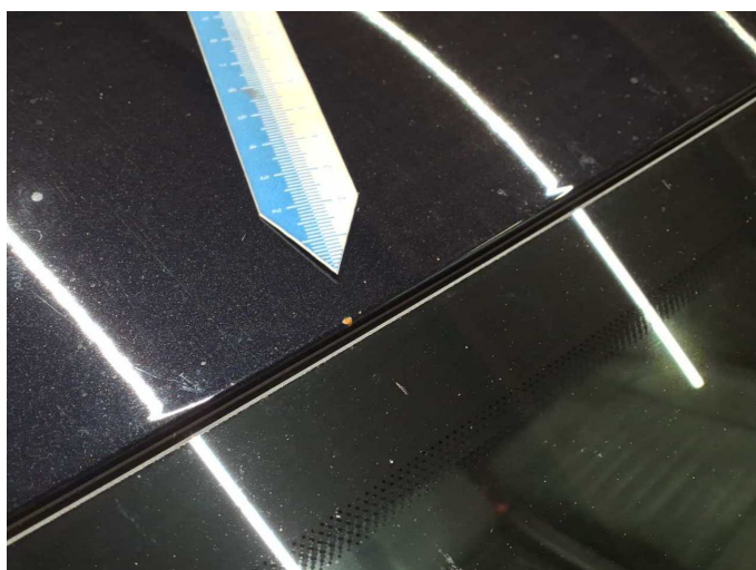
Beschädigung 18: Fahrzeugdach: Dach - Korrosion - lackieren
