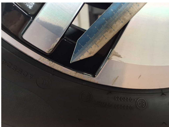
Beschädigung 11: Rad/Reifen: Leichtmetallfelge vorn rechts - verkratzt / verschürft - Wertminderung
