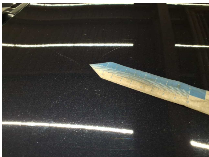
Beschädigung 16: Motorhaube: Motorhaube - Kratzer - lackieren
