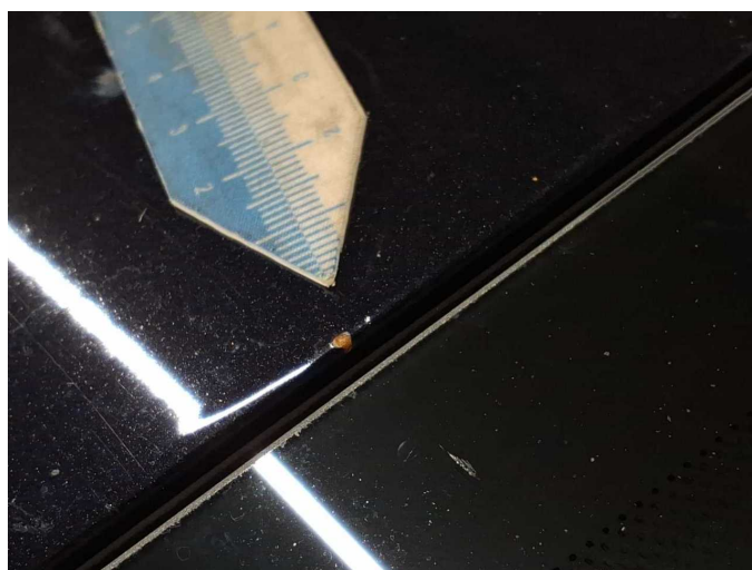
Beschädigung 18: Fahrzeugdach: Dach - Korrosion - lackieren
