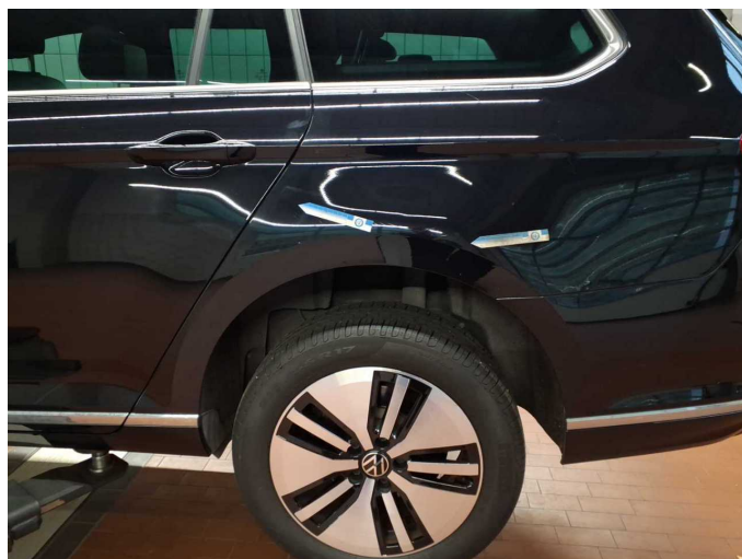
Beschädigung 8: Seitenwand links: Seitenwand - Kratzer - Smart Repair
