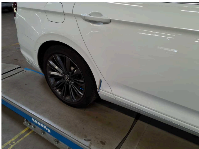
Beschädigung 4: Seitenwand rechts: Seitenwand - Delle(n) - sanft instandsetzen
