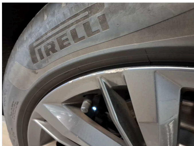
Beschädigung 8: Rad/Reifen: Leichtmetallfelge hinten links (Materialabtrag) - verkratzt / verschürft - erneuern
