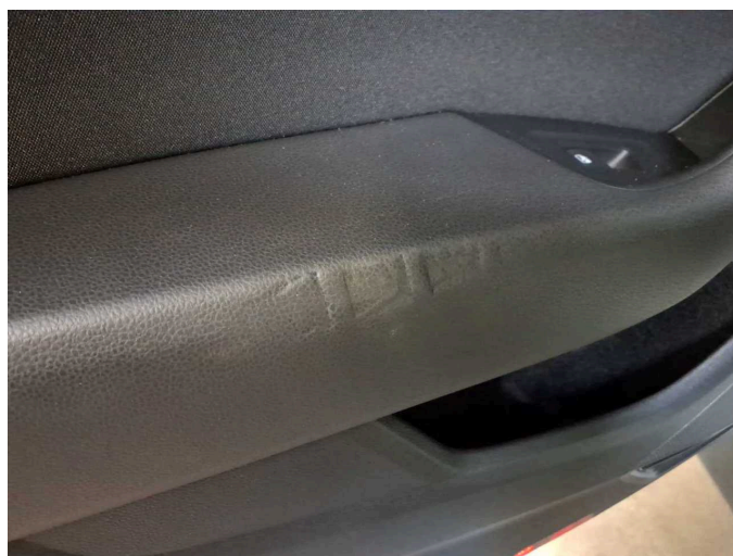
Beschädigung 5: Verkleidungen/Abdeckungen: Türverkleidung hinten links - verformt - Smart Repair
