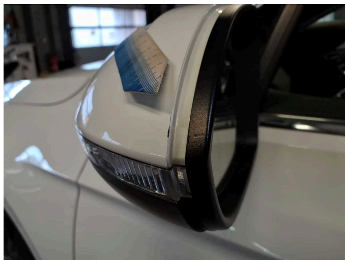
Beschädigung 2: Außenspiegel links: Abdeckkappe - Kratzer - Smart Repair
