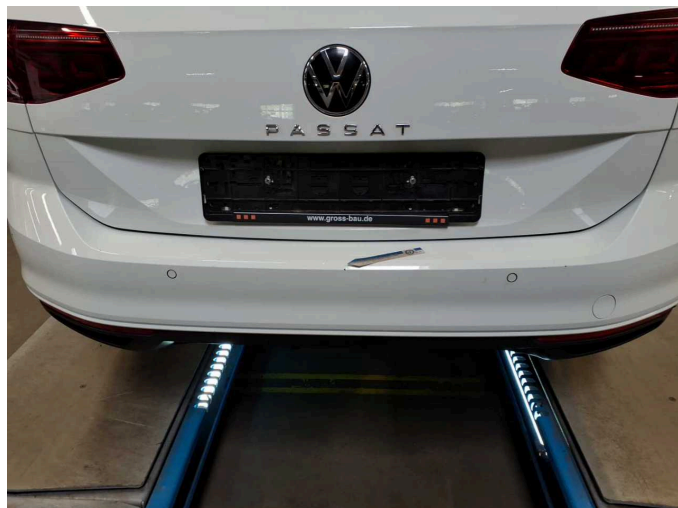
Beschädigung 10: Stossfänger hinten: Stossfänger hinten - Kratzer - lackieren
