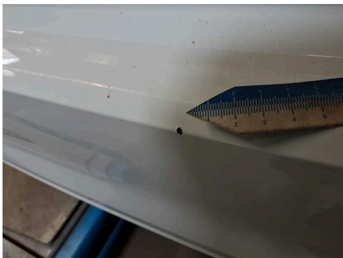
Beschädigung 10: Stossfänger hinten: Stossfänger hinten - Kratzer - lackieren
