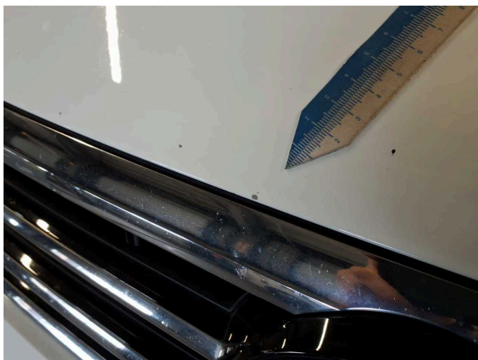
Beschädigung 11: Motorhaube: Motorhaube (Steinschlag) - verformt - instandsetzen und lackieren
