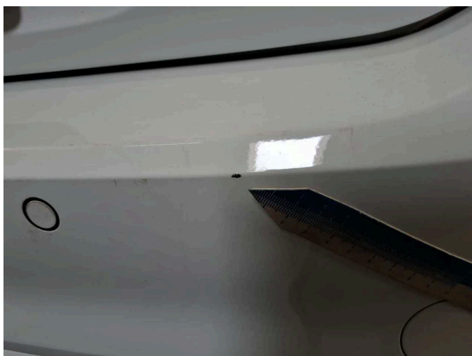
Beschädigung 10: Stossfänger hinten: Stossfänger hinten - Kratzer - lackieren
