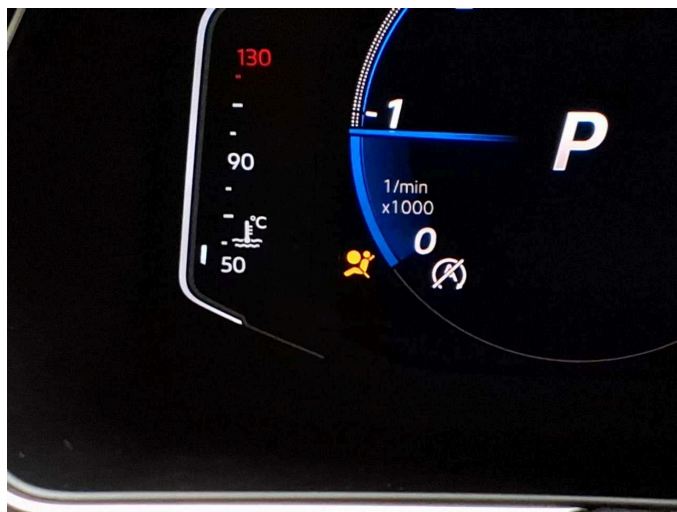
Beschädigung 7: Airbagssystem: Airbagssystem (Airbag Lampe an) - Funktion / Zulässigkeit - Diagnose durchführen
