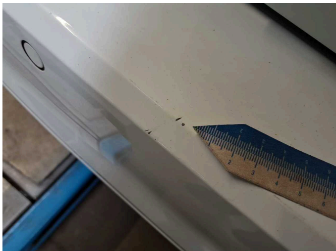
Beschädigung 10: Stossfänger hinten: Stossfänger hinten - Kratzer - lackieren
