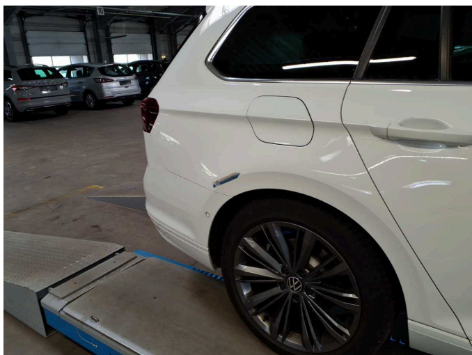
Beschädigung 4: Seitenwand rechts: Seitenwand - Delle(n) - sanft instandsetzen
