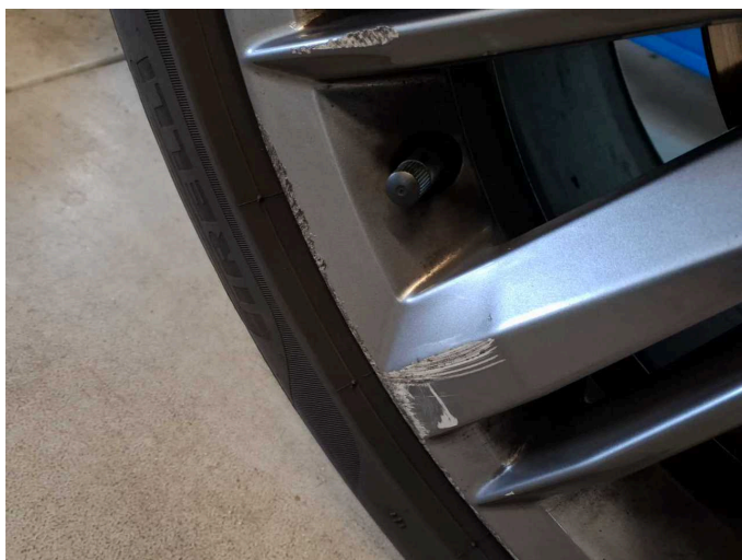
Beschädigung 9: Rad/Reifen: Leichtmetallfelge vorn links (Materialabtrag) - verkratzt / verschürft - erneuern
