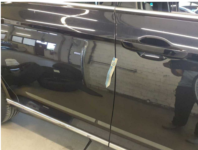
Damage 1: Door - rear right side: Door (+kratzer/gebrauchsspuren) - dent(s) - Smart repair
