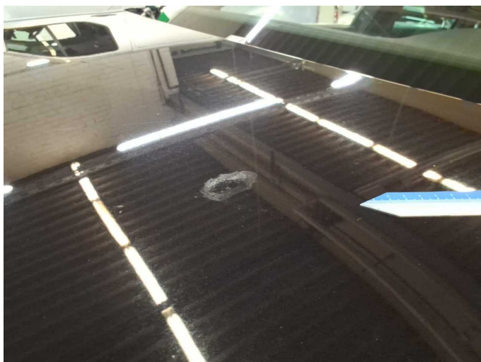
Damage 10: Bonnet: Bonnet (Vogelkotverätzung) - Paint defect - Paint
