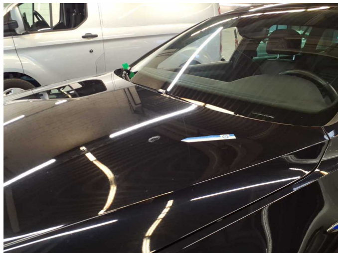
Damage 10: Bonnet: Bonnet (Vogelkotverätzung) - Paint defect - Paint
