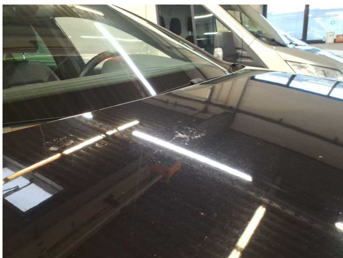
Damage 10: Bonnet: Bonnet (Vogelkotverätzung) - Paint defect - Paint
