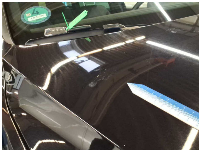
Damage 10: Bonnet: Bonnet (Vogelkotverätzung) - Paint defect - Paint
