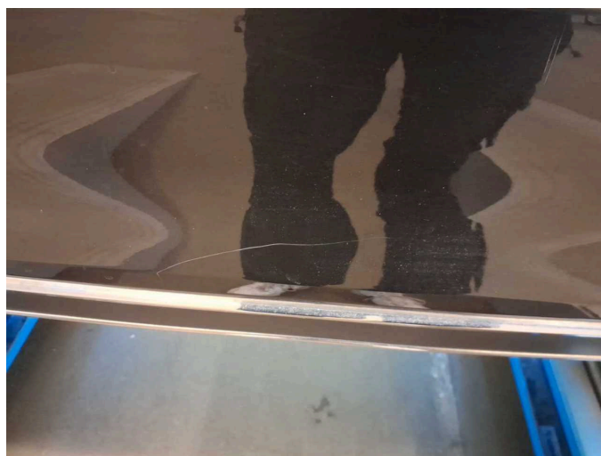
Beschädigung 4: Stossfänger hinten: Stossfänger hinten - Kratzer - lackieren
