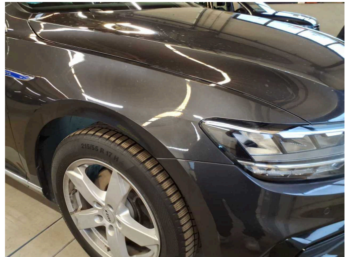
Beschädigung 2: Kotflügel rechts: Kotflügel rechts - Steinschlag - lackieren
