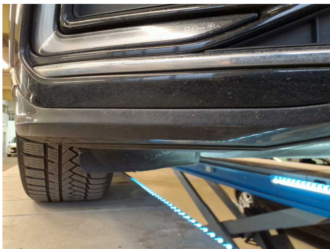
Beschädigung 3: Stossfänger vorn: Stossfänger vorn - Steinschlag - lackieren
