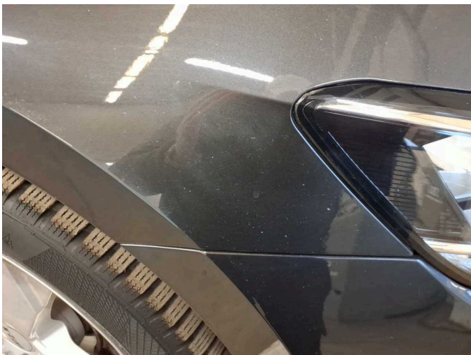
Beschädigung 2: Kotflügel rechts: Kotflügel rechts - Steinschlag - lackieren
