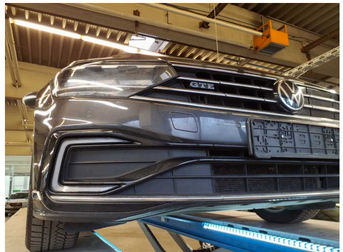
Beschädigung 3: Stossfänger vorn: Stossfänger vorn - Steinschlag - lackieren
