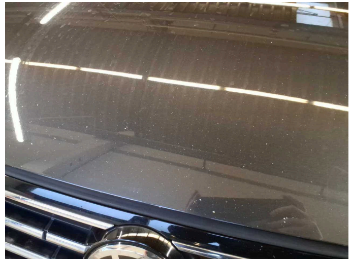
Beschädigung 5: Motorhaube: Motorhaube - Steinschlag - lackieren
