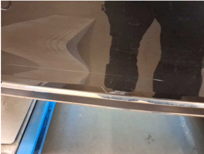
Beschädigung 4: Stossfänger hinten: Stossfänger hinten - Kratzer - lackieren
