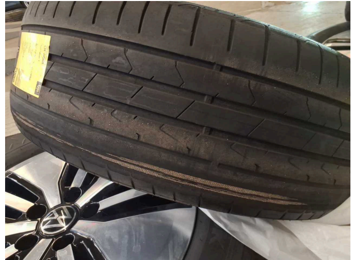
Beschädigung 1: 2.Radsatz: 1 Reifen - verschlissen - erneuern
