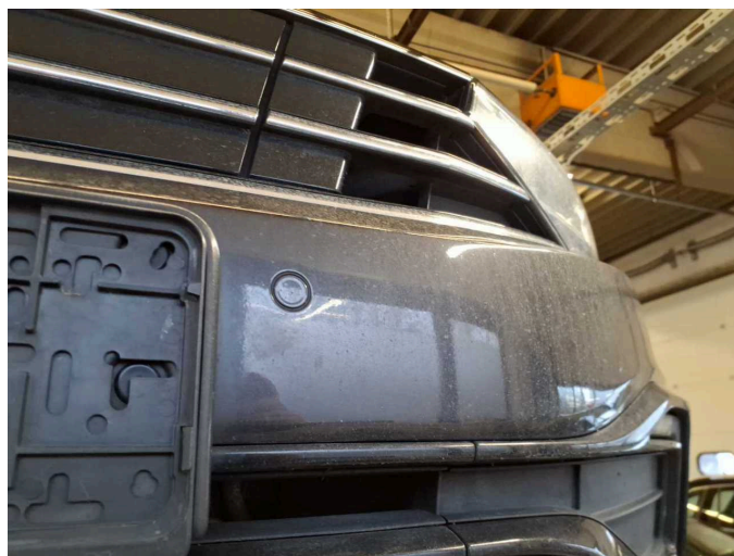
Beschädigung 3: Stossfänger vorn: Stossfänger vorn - Steinschlag - lackieren
