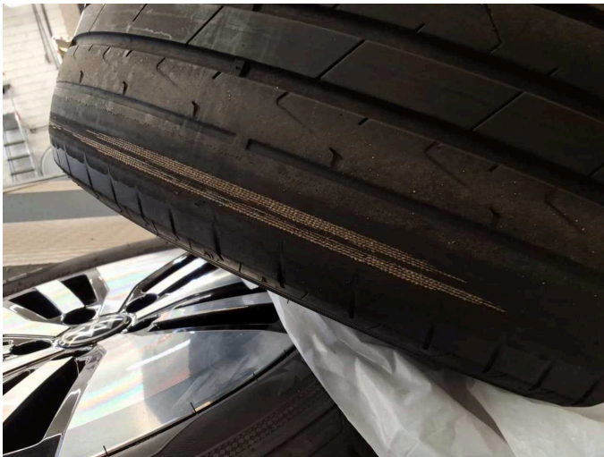
Beschädigung 1: 2.Radsatz: 1 Reifen - verschlissen - erneuern
