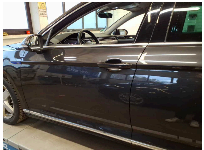
Beschädigung 6: Tür vorn links: Tür - Delle / Lackschaden - instandsetzen und lackieren
