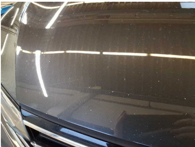
Beschädigung 5: Motorhaube: Motorhaube - Steinschlag - lackieren
