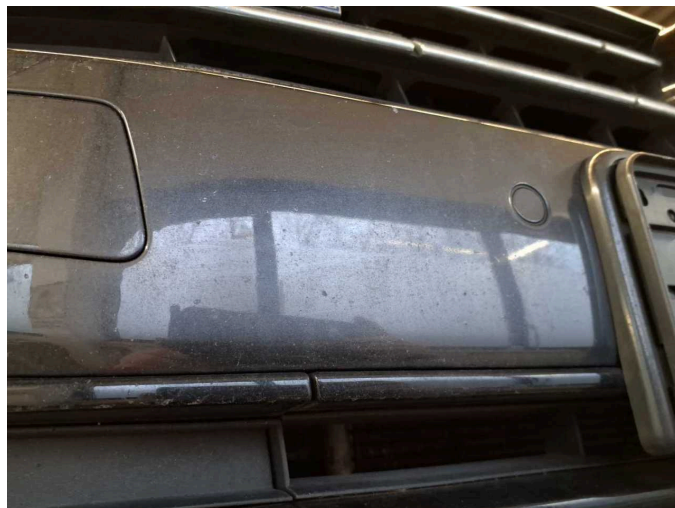
Beschädigung 3: Stossfänger vorn: Stossfänger vorn - Steinschlag - lackieren
