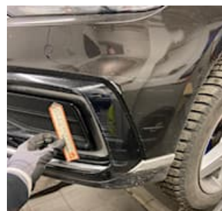
7.4.1 - Stötfångare fram Skrapmärken :: Plastreparation och lackering (2+)
