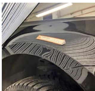
7.4.7 - Framskärm höger Grövre bucklor :: Rikt och lack (2+)
