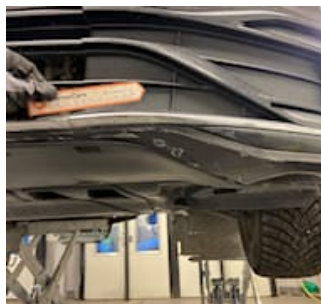
7.4.1 - Stötfångare fram Skrapmärken :: Plastreparation och lackering (2+)
