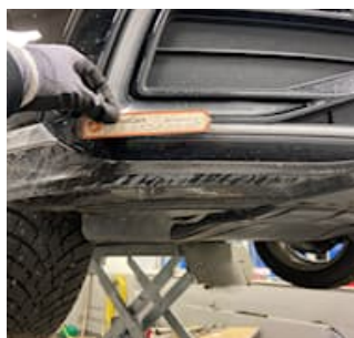
7.4.1 - Stötfångare fram Skrapmärken :: Plastreparation och lackering (2+)
