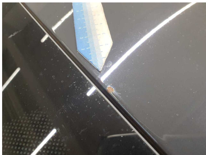
Beschädigung 7: Fahrzeugdach: Dach (Rost) - Steinschlag - lackieren
