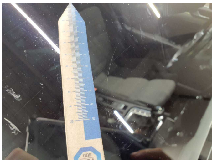
Beschädigung 8: Verglasung: Frontscheibe - Kratzer - erneuern
