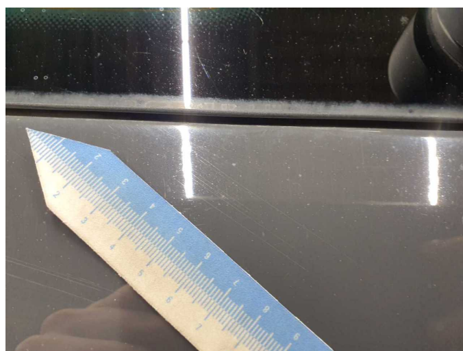
Beschädigung 6: Heckklappe/-tür: Heckklappe - Kratzer - lackieren
