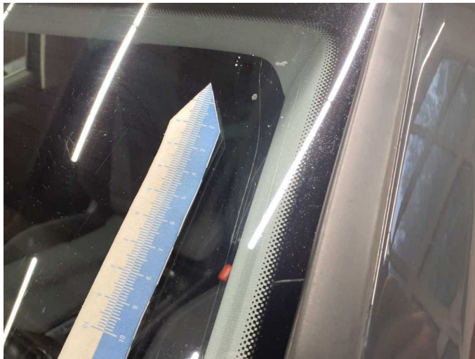
Beschädigung 8: Verglasung: Frontscheibe - Kratzer - erneuern
