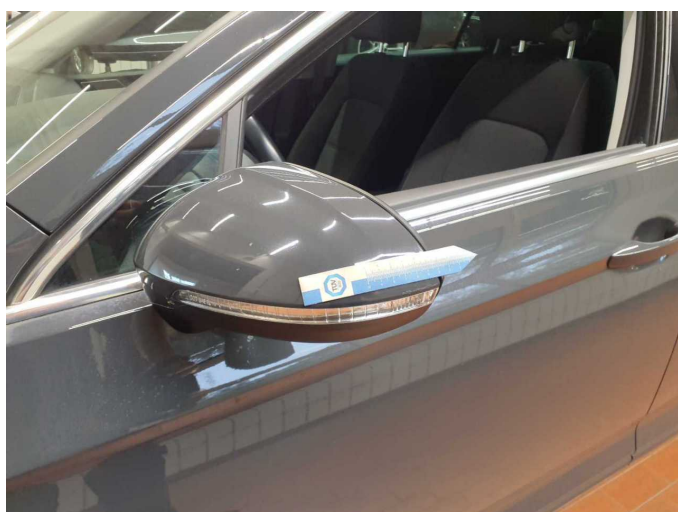
Beschädigung 1: Außenspiegel links: Abdeckkappe - Kratzer - Smart Repair
