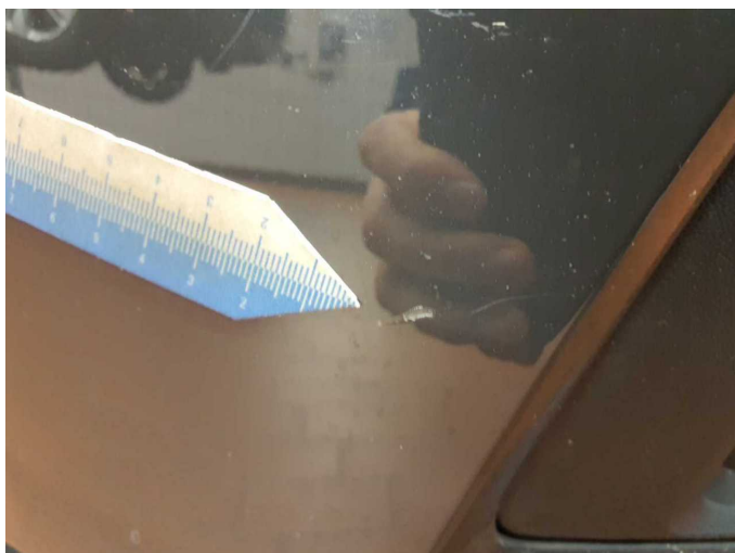
Beschädigung 3: Stossfänger vorn: Stossfänger vorn - Steinschlag - lackieren
