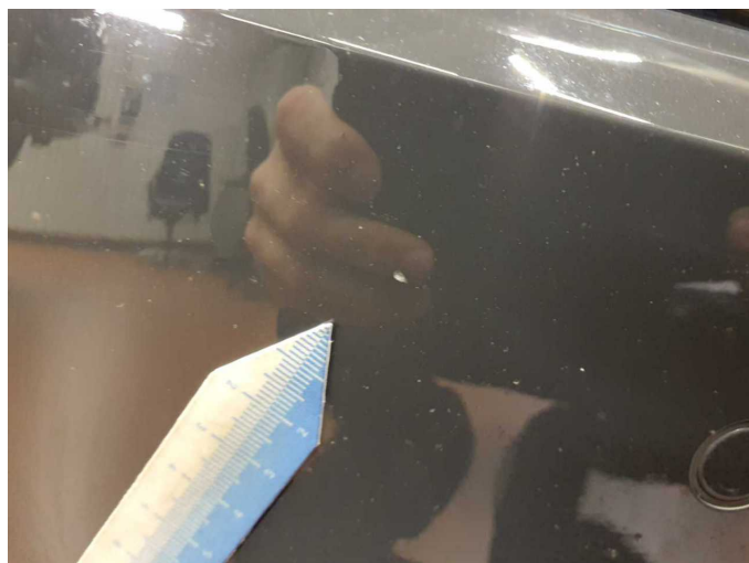
Beschädigung 3: Stossfänger vorn: Stossfänger vorn - Steinschlag - lackieren
