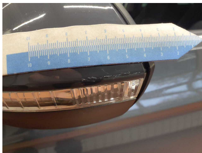
Beschädigung 1: Außenspiegel links: Abdeckkappe - Kratzer - Smart Repair
