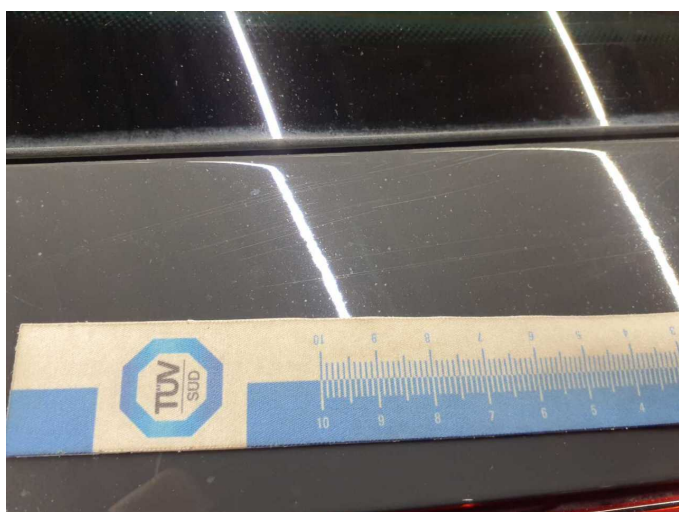
Beschädigung 6: Heckklappe/-tür: Heckklappe - Kratzer - lackieren
