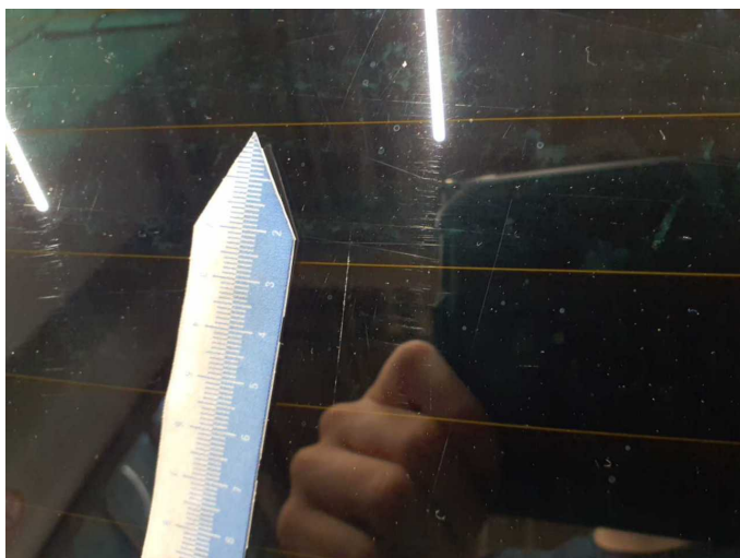
Beschädigung 5: Verglasung: Heckscheibe - verkratzt / verschürft - erneuern
