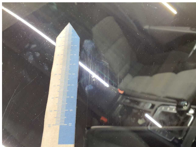
Beschädigung 8: Verglasung: Frontscheibe - Kratzer - erneuern
