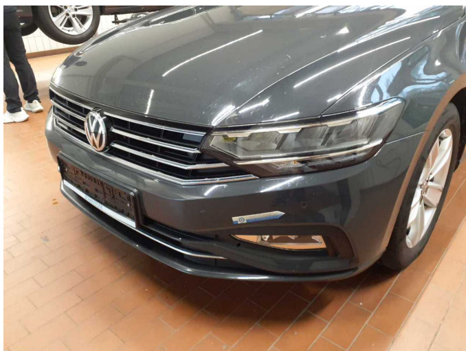
Beschädigung 3: Stossfänger vorn: Stossfänger vorn - Steinschlag - lackieren
