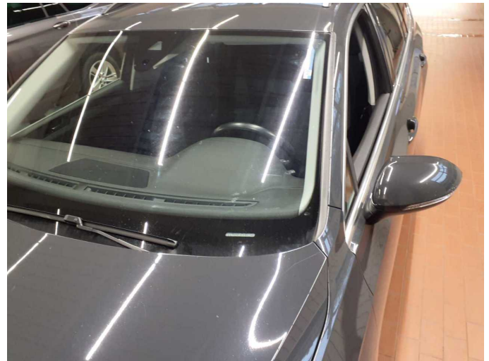
Beschädigung 8: Verglasung: Frontscheibe - Kratzer - erneuern
