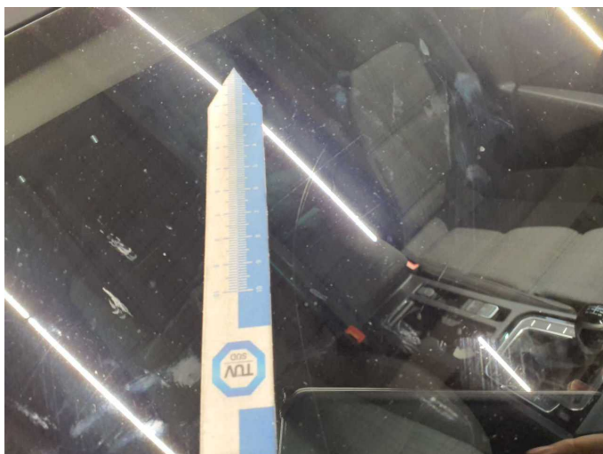
Beschädigung 8: Verglasung: Frontscheibe - Kratzer - erneuern
