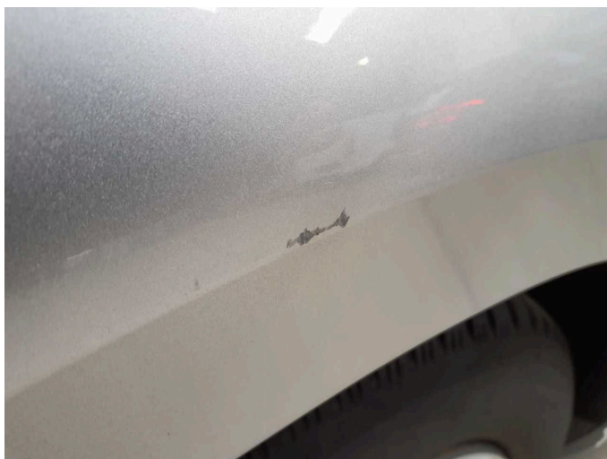
Beschädigung 5: Seitenwand rechts: Seitenwand - Kratzer - lackieren
