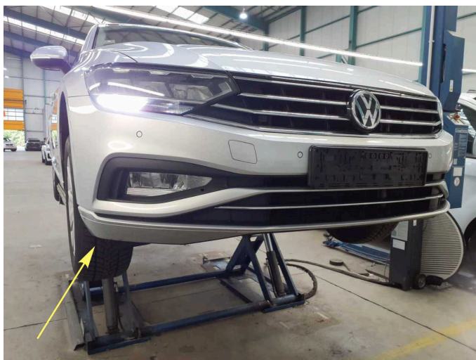
Beschädigung 3: Stossfänger vorn: Spoiler - verkratzt / verschürft - lackieren
