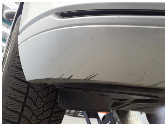
Beschädigung 3: Stossfänger vorn: Spoiler - verkratzt / verschürft - lackieren
