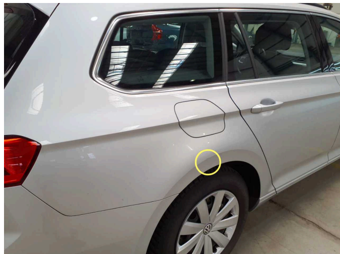
Beschädigung 5: Seitenwand rechts: Seitenwand - Kratzer - lackieren
