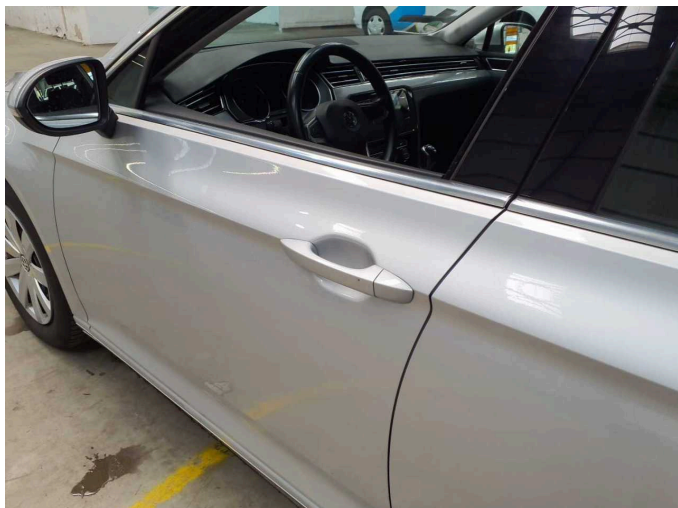
Beschädigung 2: Tür vorn links: Griff außen - Kratzer - lackieren
