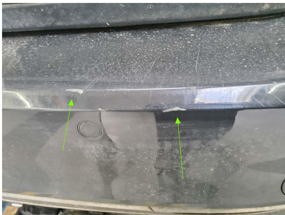
Bild 26 : Stoßstange hinten verformt
