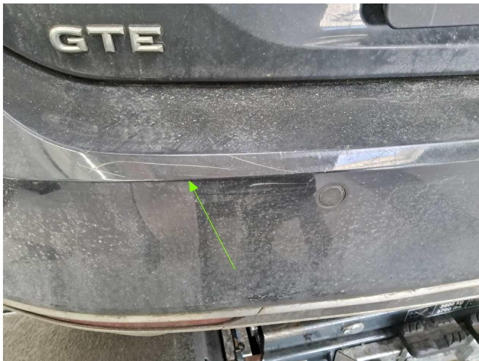
Bild 27 : Stoßstange hinten verformt
