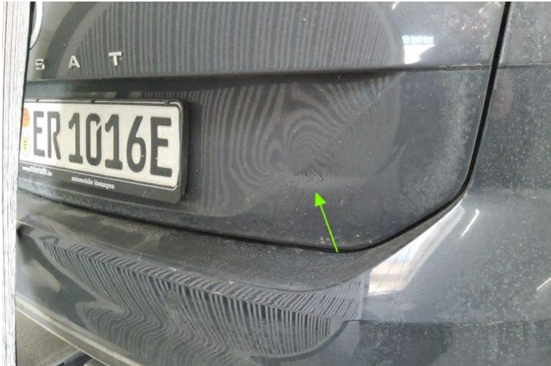
Bild 21 : Heckdeckel, deformiert, instandsetzen und lackieren mit Lackaufbau
