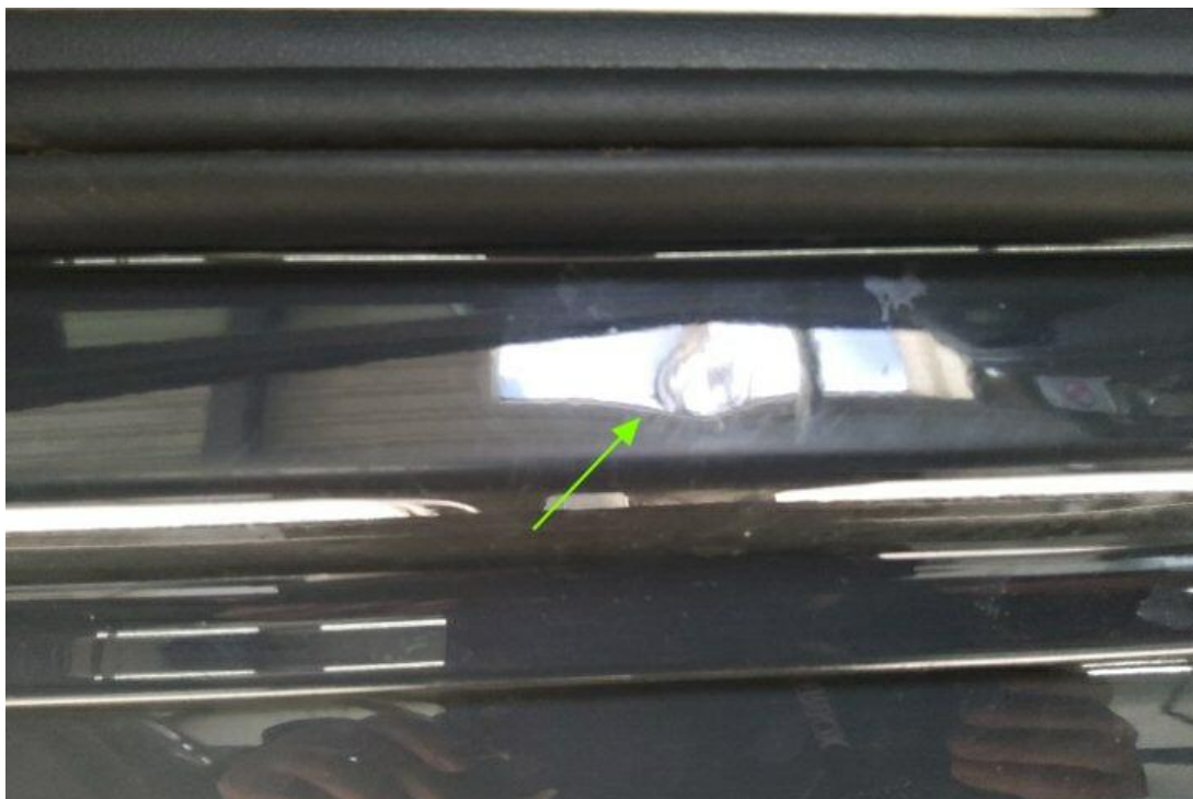
Bild 17 : Tür vorne links Einstieg, eingedellt, smart repair
