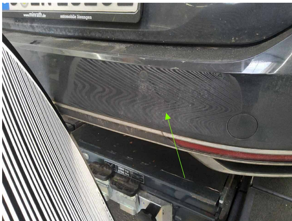
Bild 25 : Stoßstange hinten verformt
