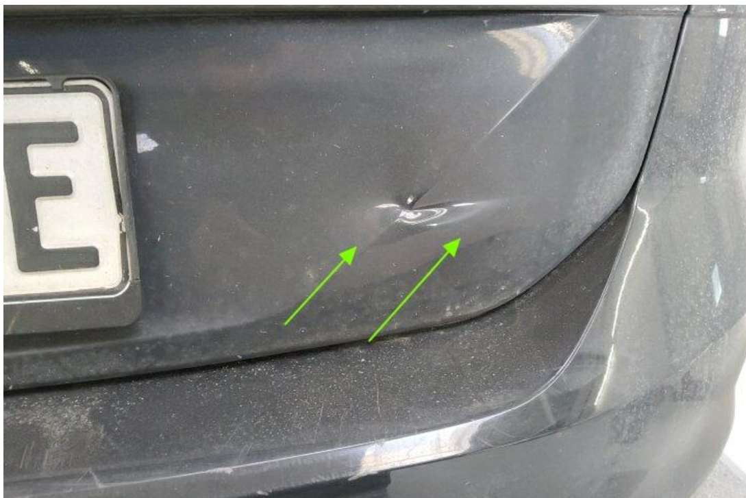
Bild 20 : Heckdeckel, deformiert, instandsetzen und lackieren mit Lackaufbau
