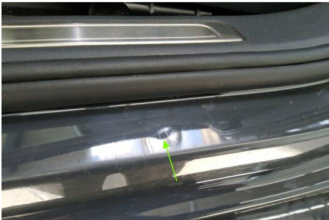
Bild 19 : Tür vorne links Einstieg, eingedellt, smart repair
