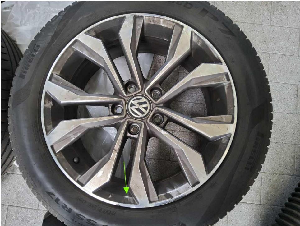
Bild 29 : Glanzgedrehte Felge vorne rechts zerkratzt
