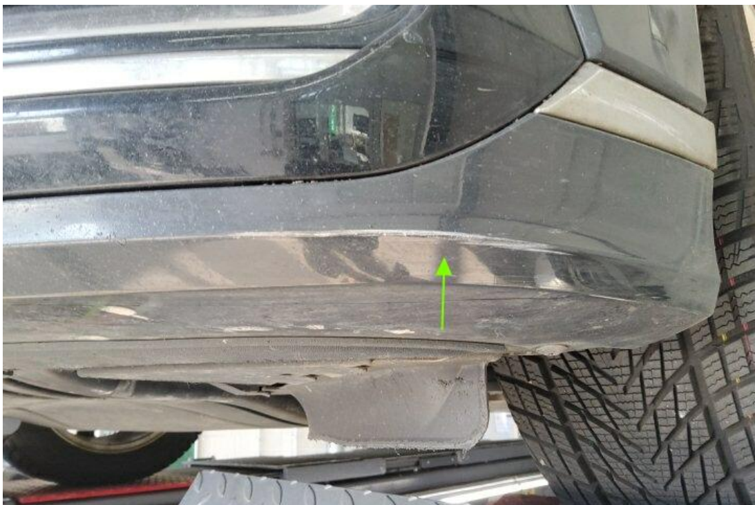
Bild 22 : Stoßfänger vorne Lackierung, zerkratzt, smart repair
