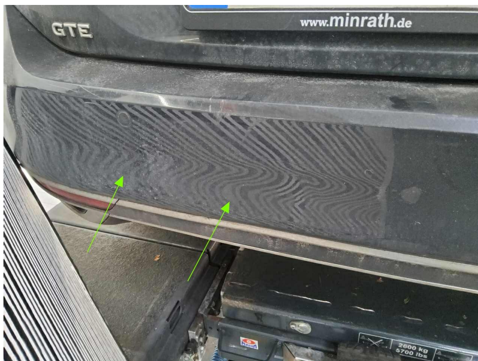
Bild 24 : Stoßstange hinten verformt
