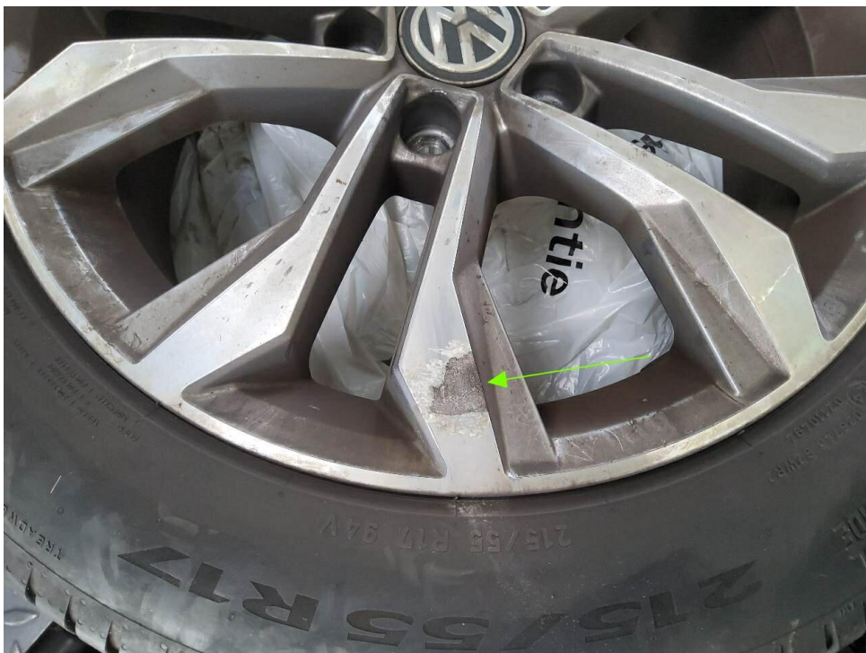
Bild 30 : Glanzgedrehte Felge hinten rechts zerkratzt
