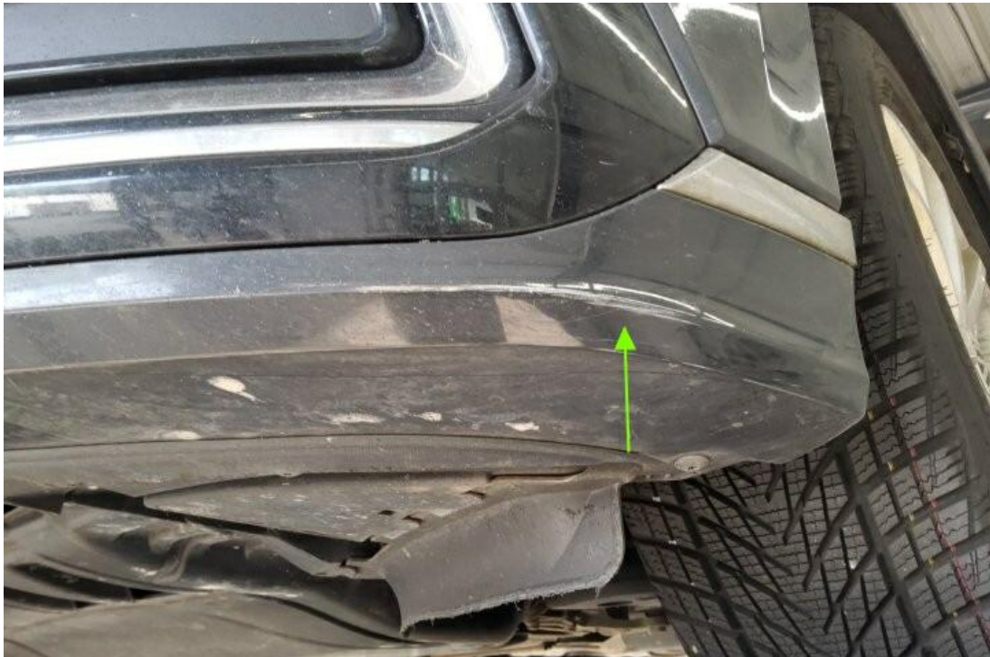
Bild 23 : Stoßfänger vorne Lackierung, zerkratzt, smart repair
