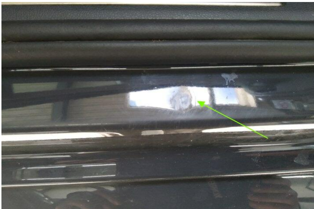
Bild 18 : Tür vorne links Einstieg, eingedellt, smart repair
