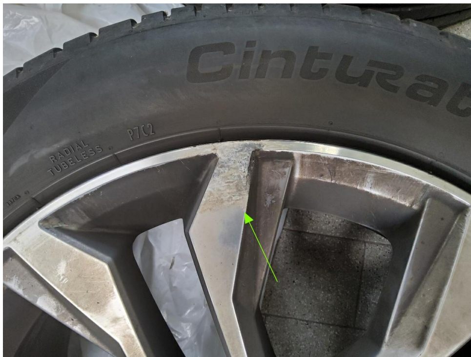
Bild 28 : Glanzgedrehte Felge vorne rechts zerkratzt
