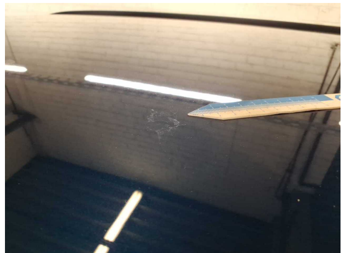
Damage 15: Roof: Roof (Vogelkotverätzung + Kratzer) - Paint defect - Paint
