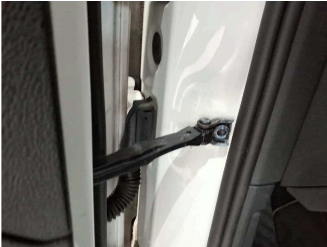
Damage 2: Door - front left side: Door (Türfangband) - Noise - Perform diagnosis
