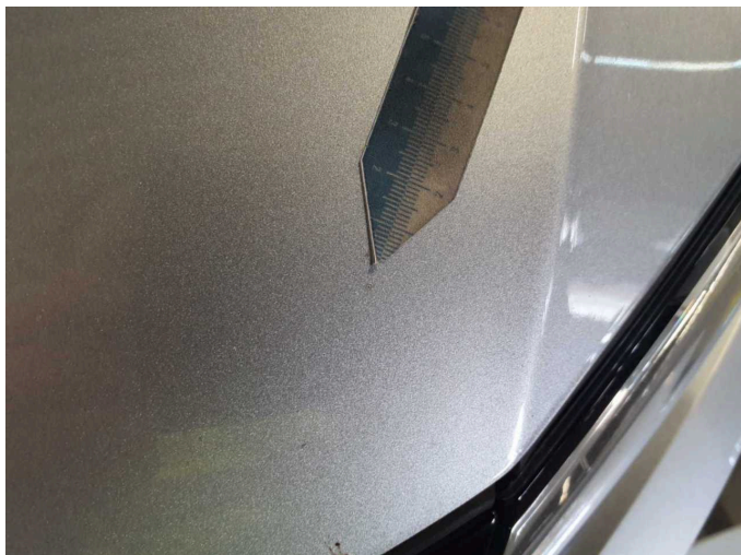
Damage 3: Bonnet: Bonnet (+ Steinschlag geht bis zur Grundierung) - dent(s) - Repair and paint
