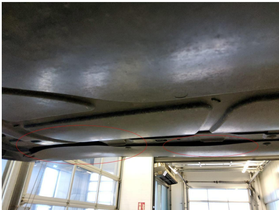
Bild 22 : Stoßfänger vorne unterhalb deformiert.
