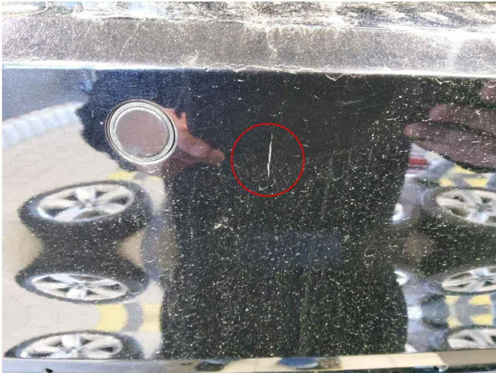
Bild 16 : Stoßfänger hinten Lackierung, zerkratzt, lackieren mit Lackaufbau
