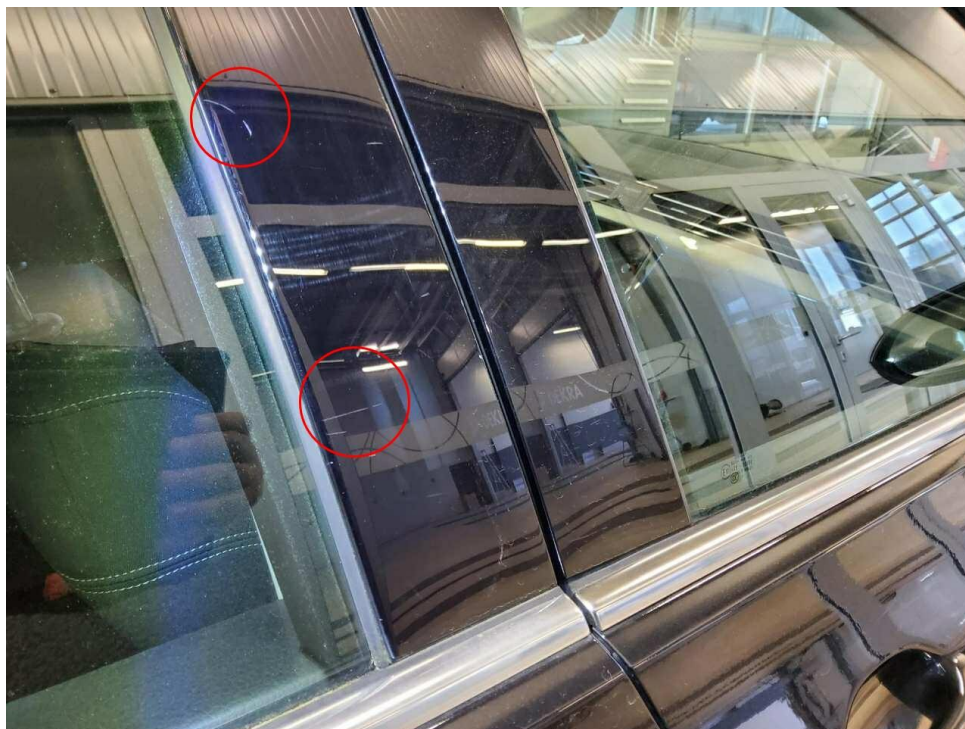
Bild 18 : Tür hinten links Zierleiste mitte, zerkratzt, polieren
