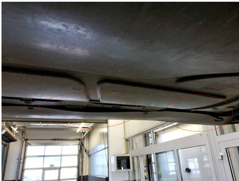
Bild 23 : Stoßfänger vorne unterhalb deformiert.
