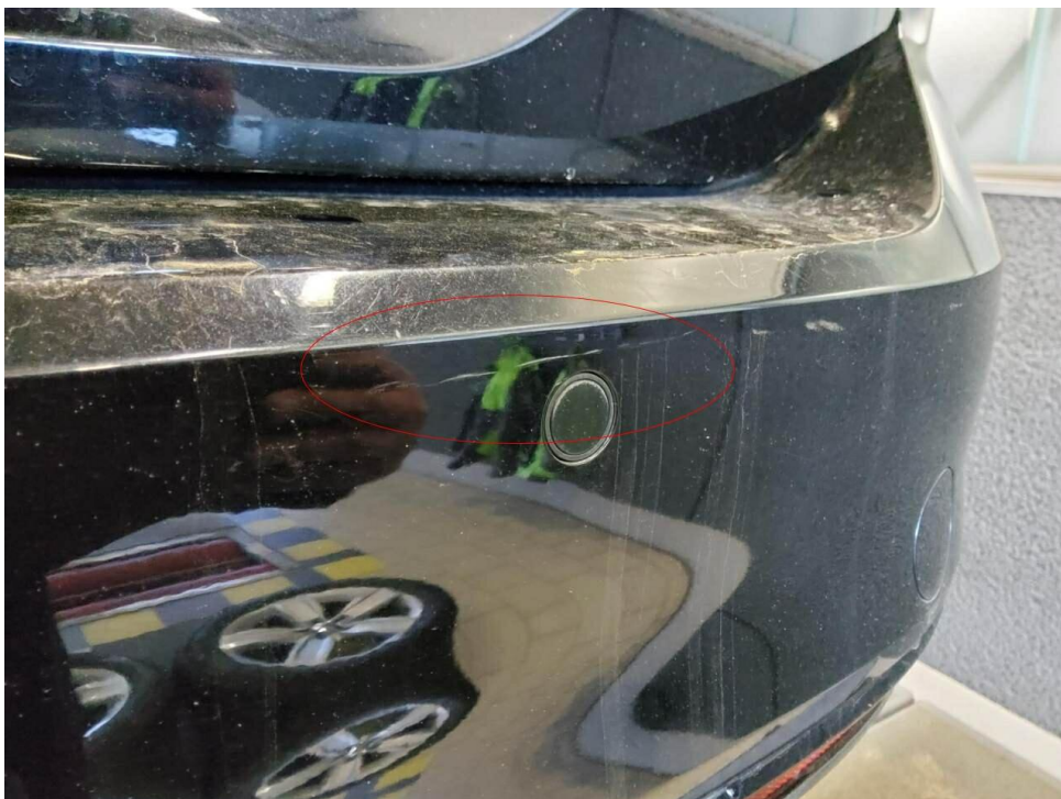
Bild 17 : Stoßfänger hinten Lackierung, zerkratzt, lackieren mit Lackaufbau
