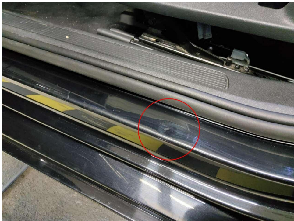
Bild 19 : Tür vorne links Einstieg, eingedellt, instandsetzen und lackieren mit Lackaufbau
