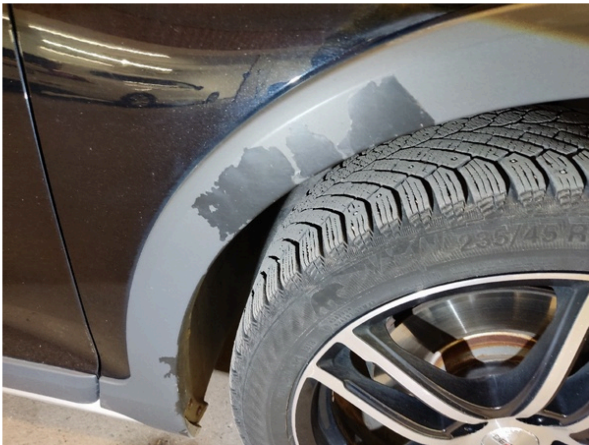
Skärm Höger fram Lackskador
