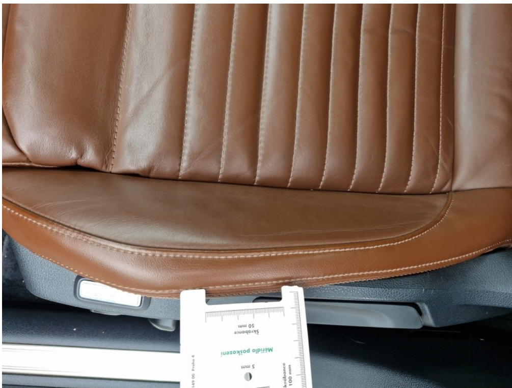
29 Potah sedáku sedadla řidiče - Opotřebení Umístění: Interiér (vnitřní prostor)
