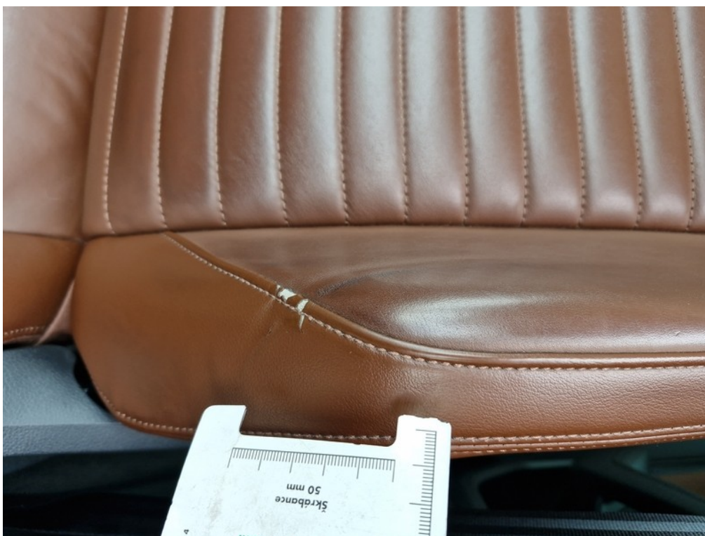
30 Potah opěradla sedadla řidiče - Opotřebení Umístění: Interiér (vnitřní prostor)
