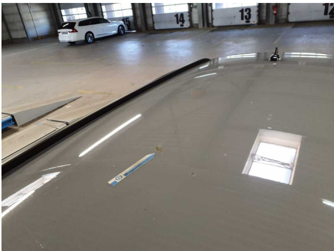
Damage 2: Roof: Roof (Verätzung durch Vogelkot, Mehrkosten möglich) - Paint defect - Conditioning
