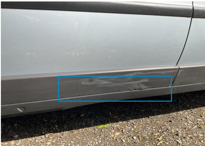
7. Door / Back Right Bodywork / Breakage -
