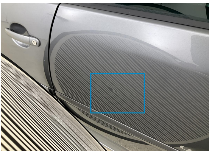
29. Door / Back Left Bodywork / Dent / Dent -
