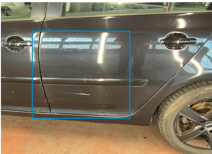
22. Door / Back Left Bodywork / Dent -
