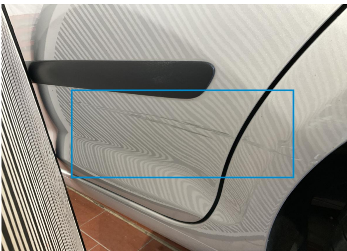
24. Door / Back Left Bodywork / Dent / Dent -
