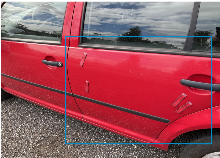
2. Door / Back Left Bodywork / Dent / Dent -
