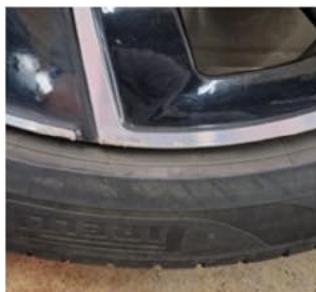
6.3.4 - Fälg vänster bak Kantstött :: Spot repair 3000 kr
