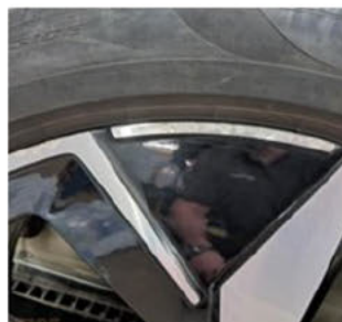
6.3.4 - Fälg vänster bak Kantstött :: Spot repair 3000 kr
