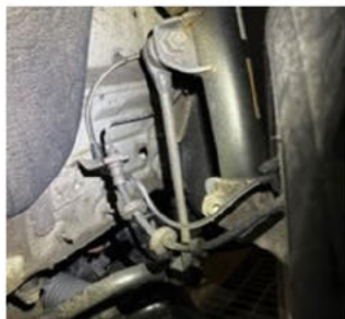
2B.1 - Stabiliseringsstag VF Byte av stabilisatorstag, missljud
