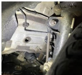
2B.2 - Stabiliseringsstag HF Byte av stabilisatorstag, missljud
