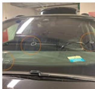
7.1 - Vindruta Stenskott med spricka, anmälan? :: Byte av vindruta
