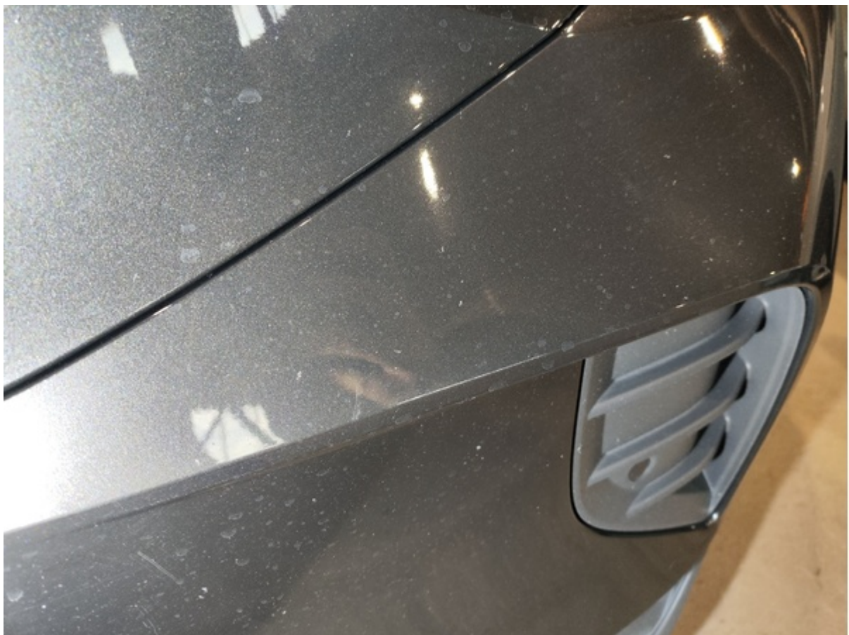
Stötfångare Fram Stenskott flertal 800 kr
