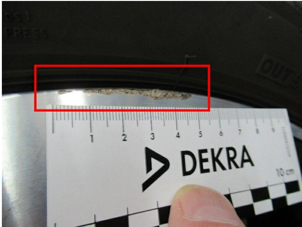
Bild 21 : Leichtmetallfelge vorne rechts (Sommerrad teilweise glanzgedreht), zerkratzt mit Materialabtrag
