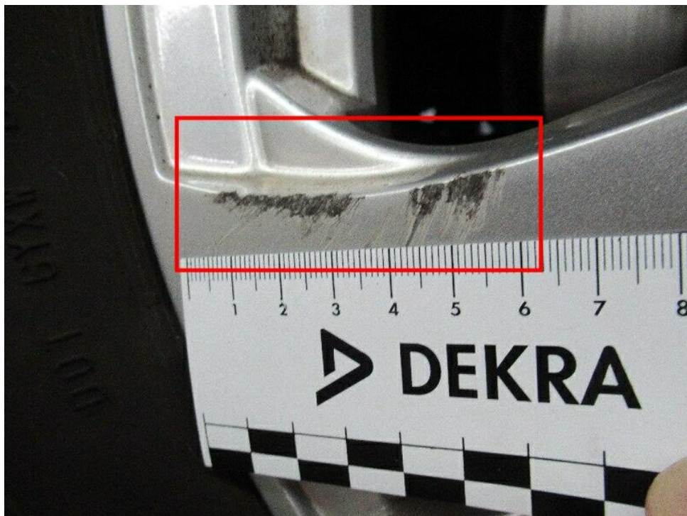
Bild 24 : Leichtmetallfelge (Winterrad Zubehör hinten links), zerkratzt mit Materialabtragungen
