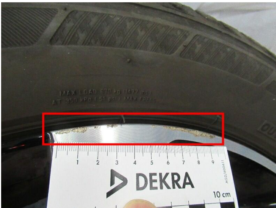
Bild 20 : Leichtmetallfelge vorne rechts (Sommerrad teilweise glanzgedreht), zerkratzt mit Materialabtrag
