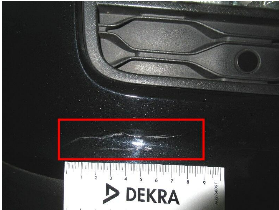
Bild 17 : Stoßfänger vorne rechts zerkratzt
