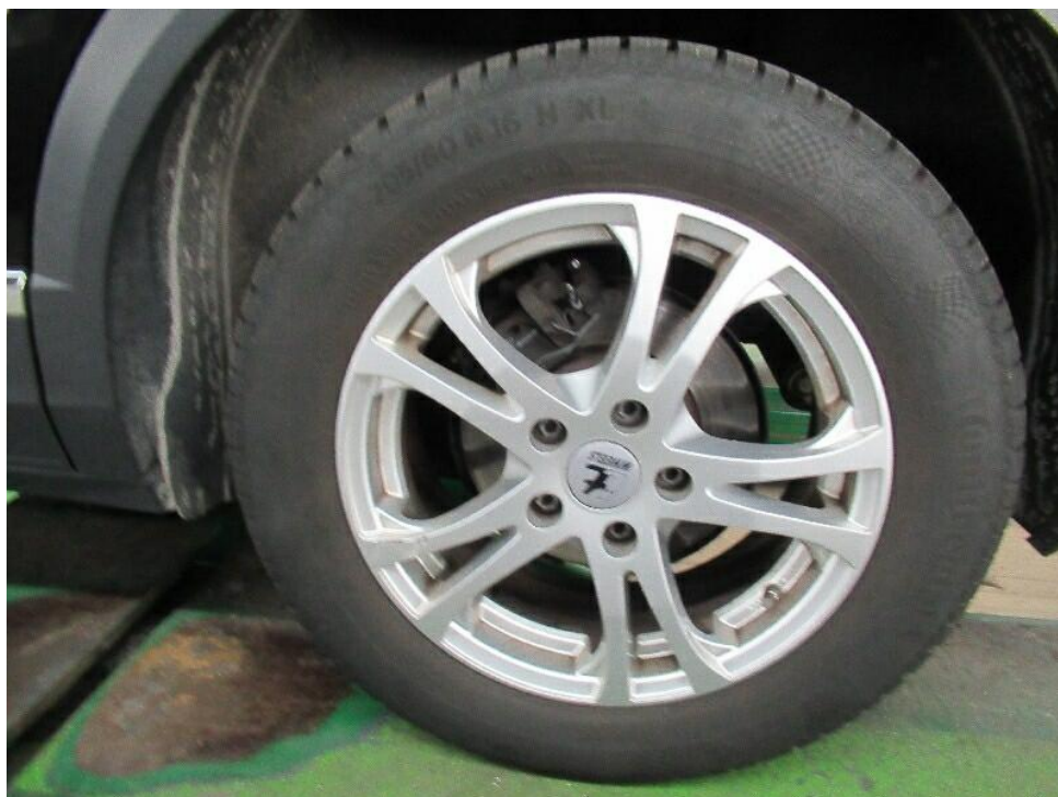
Bild 22 : Leichtmetallfelge (Winterrad Zubehör hinten links), zerkratzt mit Materialabtragungen
