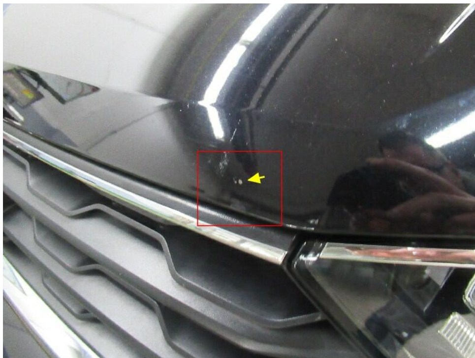
Bild 25 : Motorhaube Steinschlag, Gebrauchsspur
