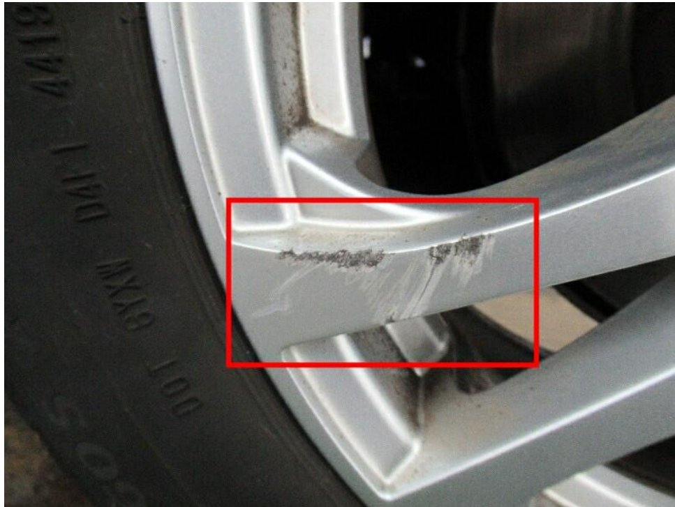
Bild 23 : Leichtmetallfelge (Winterrad Zubehör hinten links), zerkratzt mit Materialabtragungen
