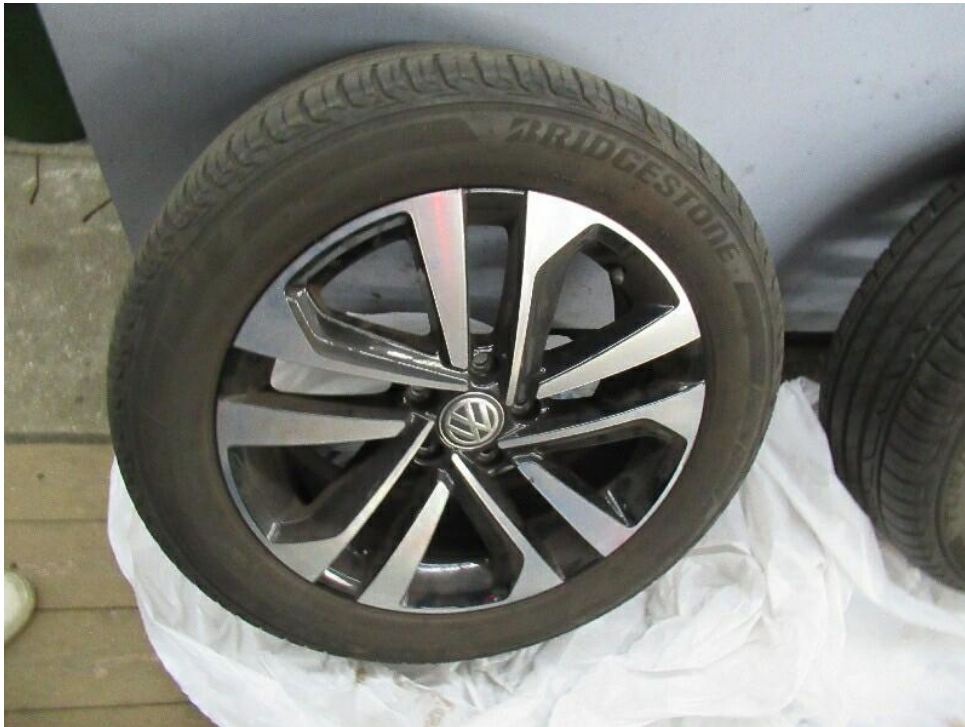
Bild 19 : Leichtmetallfelge vorne rechts (Sommerrad teilweise glanzgedreht), zerkratzt mit Materialabtrag
