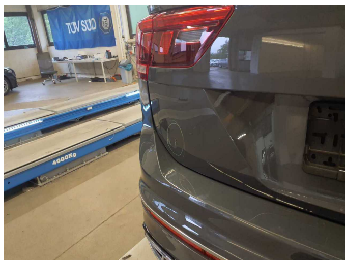
Beschädigung 4: Heckklappe/-tür: Heckklappe - verformt - instandsetzen und lackieren
