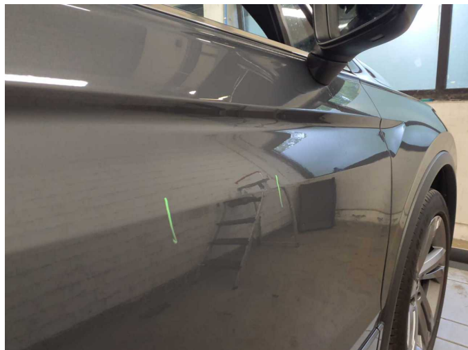
Beschädigung 3: Tür vorn rechts: Tür - nicht fachgerecht instandgesetzt - instandsetzen und lackieren
