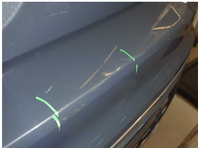
Beschädigung 1: Stossfänger hinten: Stossfänger hinten - Kratzer - lackieren
