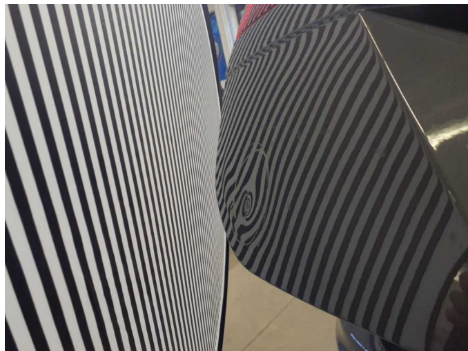
Beschädigung 4: Heckklappe/-tür: Heckklappe - verformt - instandsetzen und lackieren
