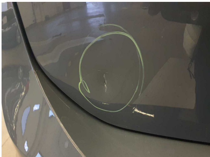
Beschädigung 4: Heckklappe/-tür: Heckklappe - verformt - instandsetzen und lackieren
