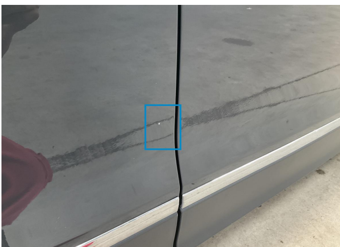
10. Door / Back Right Paint / Stone Chip -
