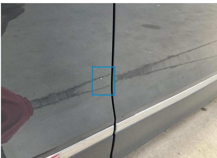
10. Door / Back Right Paint / Stone Chip -
