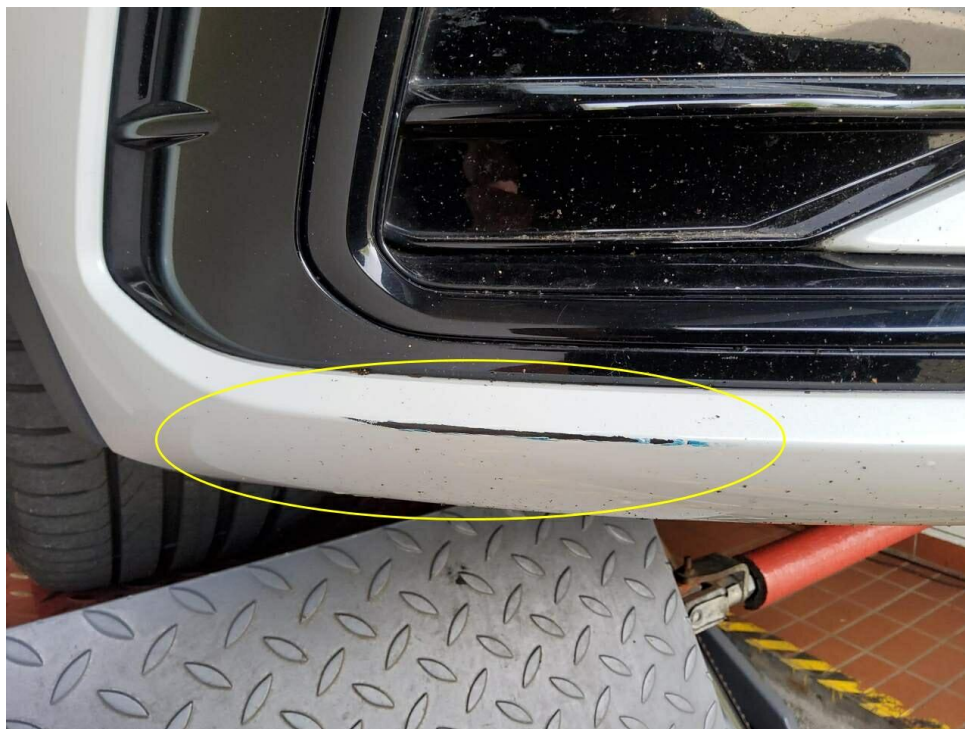
Bild 17 : Stoßfänger vorne Lackierung, zerkratzt, lackieren mit Lackaufbau
