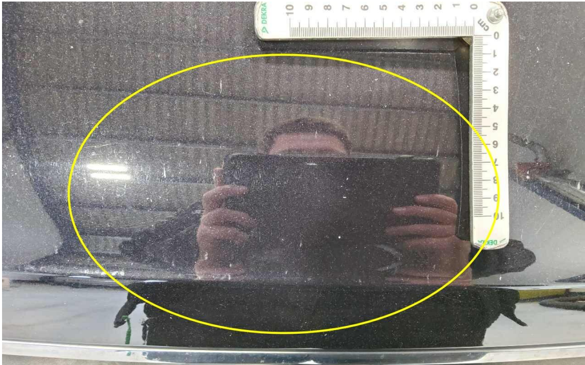
Bild 7 : Motorhaube, Steinschlag, lackieren
