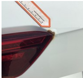
7.4.14 - Baklucka Rost angrep enligt bild/ lackering
