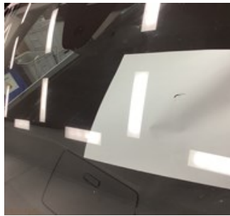
7.1 - Vindruta Stenskott vid synfältet
