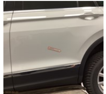
7.4.6 - Bakdörr vänster Buckla/ rikt spotrepair
