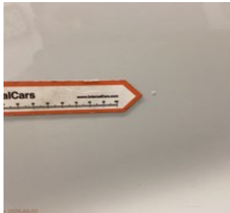
7.4.6 - Bakdörr vänster Buckla/ rikt spotrepair
