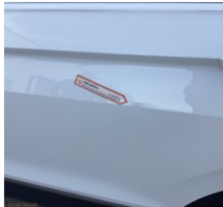
7.4.6 - Bakdörr vänster Buckla/ rikt spotrepair
