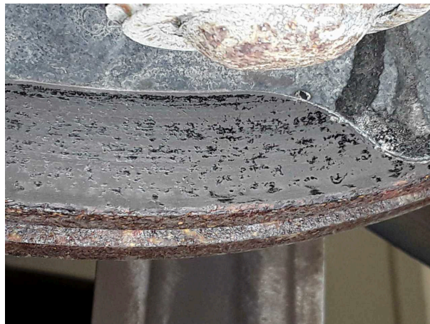
Beschädigung 2: Bremsanlage: Bremsscheiben vorn - Korrosion - erneuern
