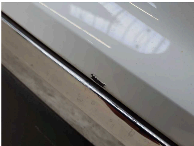
Beschädigung 2: Stossfänger hinten: Stossfänger hinten - Kratzer - lackieren
