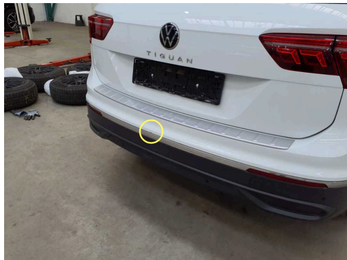
Beschädigung 2: Stossfänger hinten: Stossfänger hinten - Kratzer - lackieren
