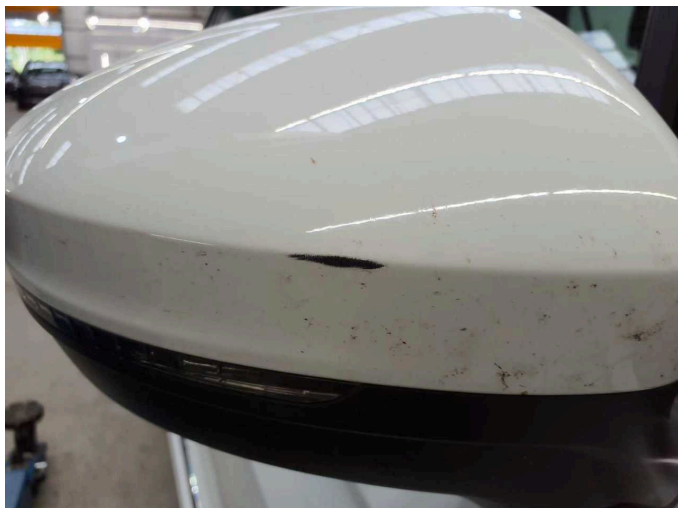
Beschädigung 1: Außenspiegel rechts: Abdeckkappe - verkratzt / verschürft - lackieren
