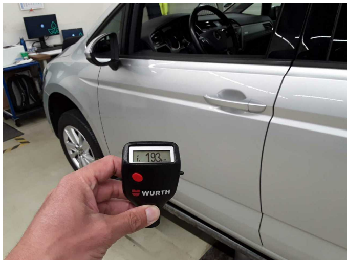
Door - front left side: 193 µm
