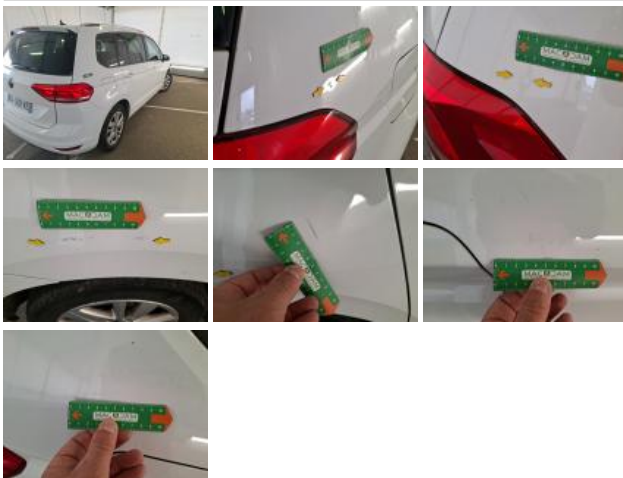
Bas de caisse ext D, Bosse(s), LI - Réparer et peindre (complet)
