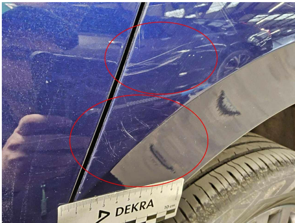
Bild 8 : Seitenteil hinten links Lackierung, verschrammt, lackieren
