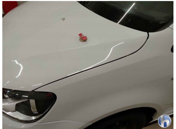
2. Fahrzeug (Farbtonunterschied, Spaltmaße ungenau )
