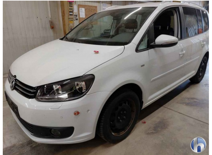
2. Fahrzeug (Farbtonunterschied, Spaltmaße ungenau )
