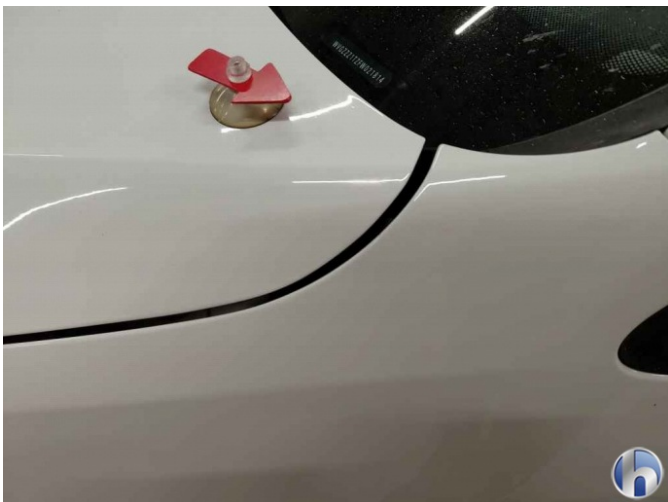
2. Fahrzeug (Farbtonunterschied, Spaltmaße ungenau )
