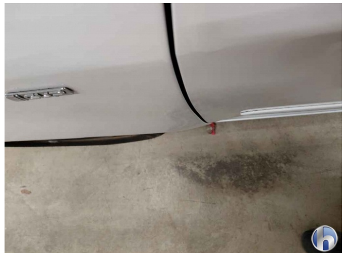
2. Fahrzeug (Farbtonunterschied, Spaltmaße ungenau )
