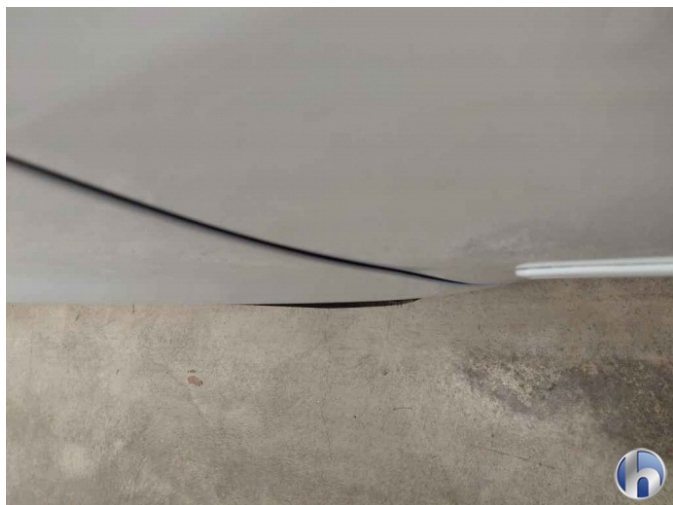
2. Fahrzeug (Farbtonunterschied, Spaltmaße ungenau )
