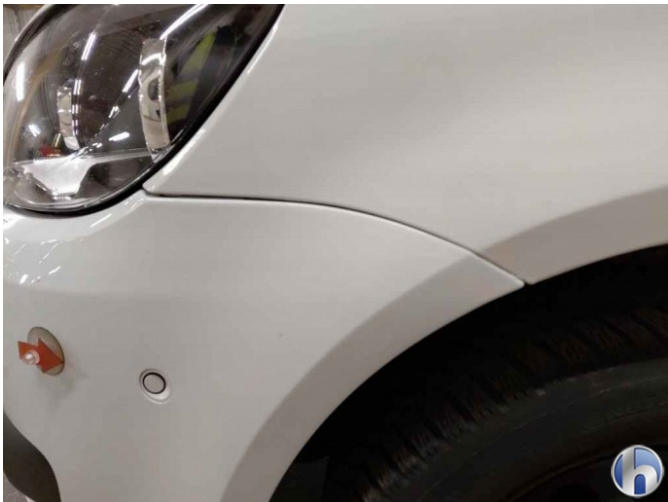
2. Fahrzeug (Farbtonunterschied, Spaltmaße ungenau )
