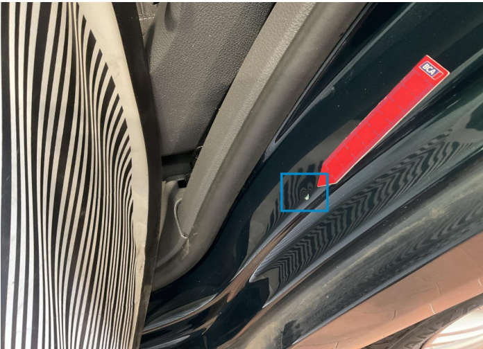
3. Door Edge / Back Left Bodywork / Dent / Dent -
