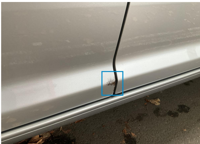
27. Door / Front Left Paint / Corrosion -
