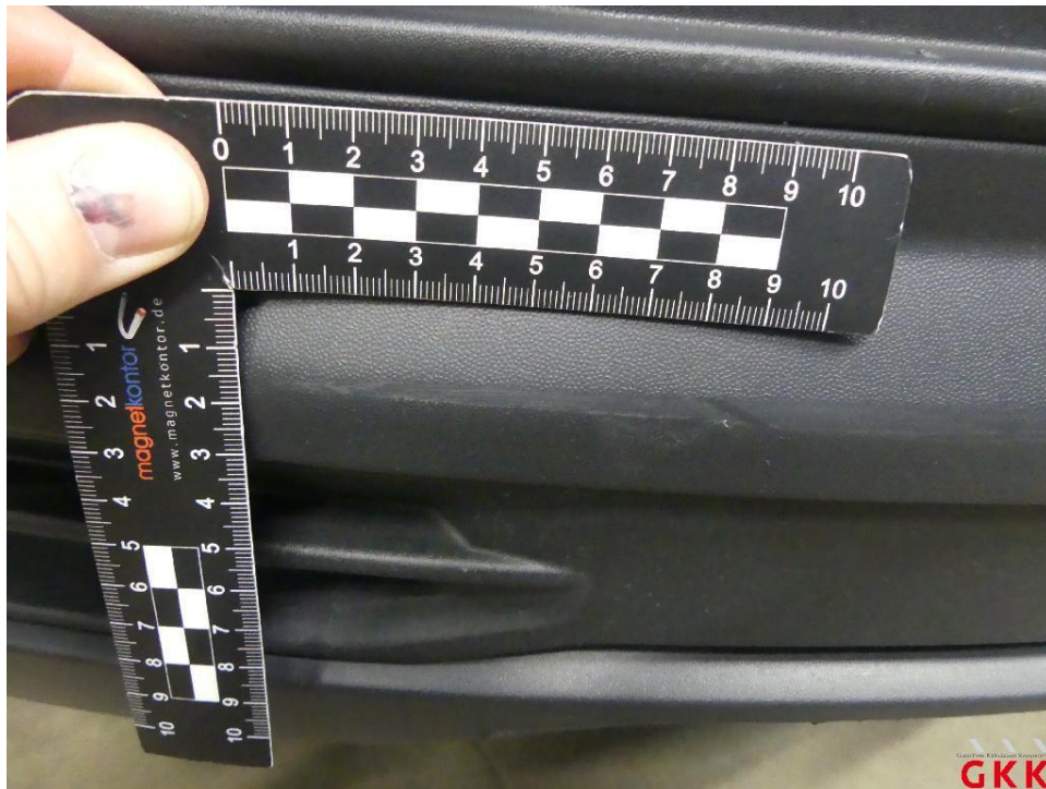
Bild 21 Stoßfänger vorne, Verkleidung -unlackiert-, verkratzt, ersetzen
