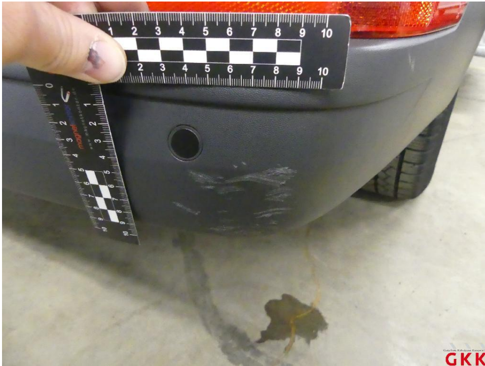
Bild 27 Stoßfänger hinten, Verkleidung -unlackiert-, verkratzt, ersetzen
