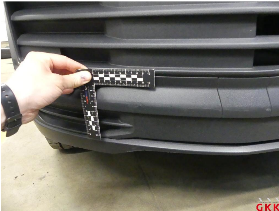
Bild 20 Stoßfänger vorne, Verkleidung -unlackiert-, verkratzt, ersetzen
