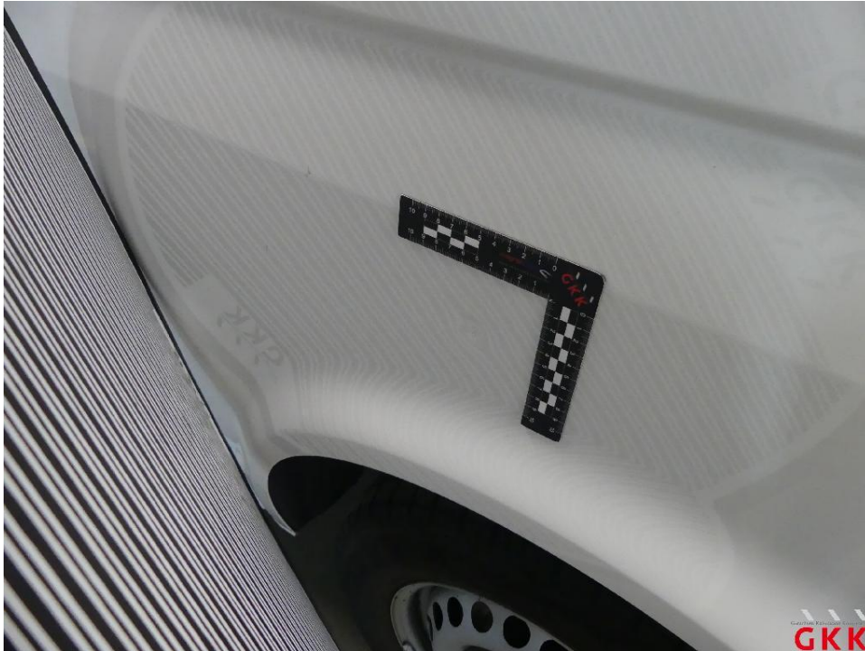
Bild 35 Seitenwand links, beschädigt, instand setzen - lackieren
