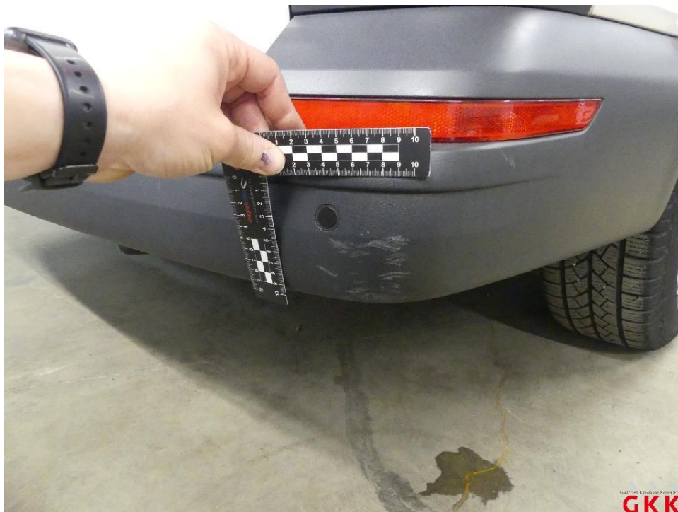
Bild 26 Stoßfänger hinten, Verkleidung -unlackiert-, verkratzt, ersetzen
