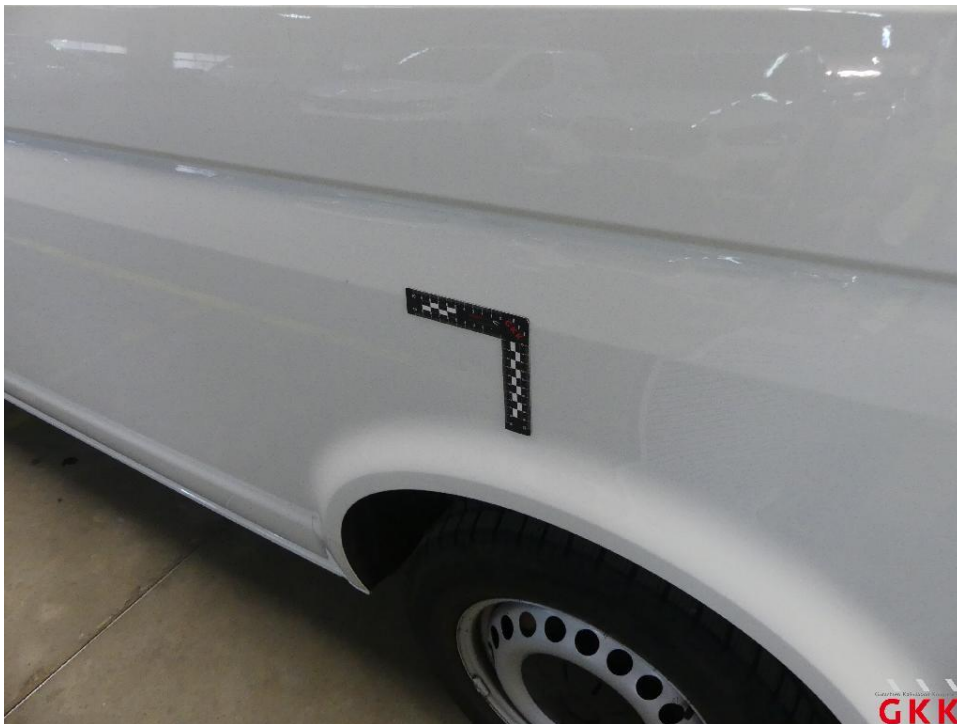
Bild 34 Seitenwand links, beschädigt, instand setzen - lackieren
