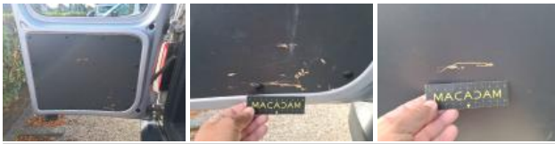
Boot door lining R, Scratch(es), Acceptable
